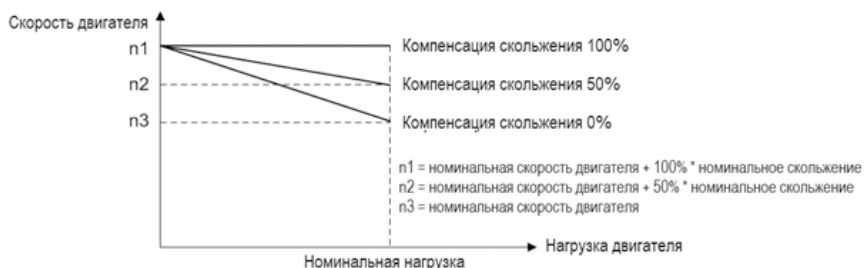
Компенсация скольжения в режиме вращения двигателя
