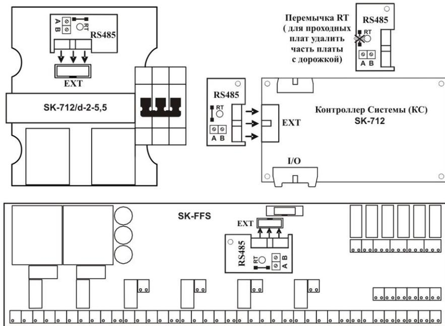
Клеммы А-В предназначены для подключения к шине RS485. При построении шины RS485 необходимо учитывать, что на оконечных платах RS485 требуется оставить перемычки RT, а на проходных платах необходимо удалить перемычки RT (удалить часть платы с дорожкой).
