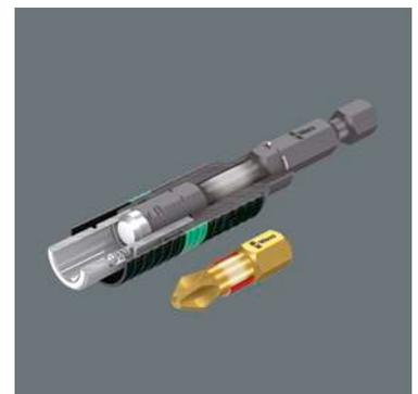
Оптимально согласованные характеристики торсионных зон бита и держателя обеспечивают ступенчатую амортизацию пиков нагрузки. Двухступенчатая система предотвращает преждевременный износ. Кроме того, твердость насадок, предназначенная для соответствующих условий применения, также гарантирует долгий срок службы инструмента.
