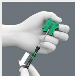
С помощью приспособления для намагничивания и размагничивания Wera: Просто провести отверткой вдоль выемки с положительным зарядом приспособления Wera. Теперь инструмент будет прочно удерживать винт.
