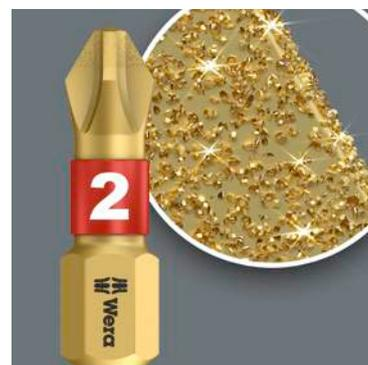
Алмазные микрочастицы, нанесенные на наконечник бита, буквально вгрызаются в винт и обеспечивают точную и надежную посадку в профиле головки. Надежная посадка продлевает жизнь винта. Значительно уменьшается выталкивающая сила, заставляющая прибегать к большему нажиму на инструмент.
