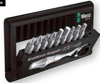
9 битов, закалённых до вязкой твердости, идеально для заворачивания с нагрузкой, например, в металлические листы или металл. 1 трещотка Zyklus Mini 1 Wera, ковкая стальная конструкция; подходит для насадок с шестигранным хвостовиком 1/4" по стандарту DIN ISO 1173-C 6,3 и E 6,3, а также с типом хвостовика Wera 1 и 4; с применением адаптера Wera 870/1 возможно также использование головок 1/4"
