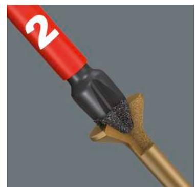
Эти алмазные частицы при машинном заворачивании снижают силы смещения, из-за которого инструмент может выскользнуть из головки винта. Алмазные частицы „вгрызаются“ в винт. Благодаря этому машинное заворачивание требует меньших усилий для нажатия на инструмент, усталость от работы наступает заметно позже.
