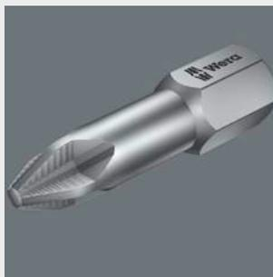
ACR® означает Anti-Cam-Out Ribs. Насадки ACR® имеют ребра в ведомом наконечнике, которые защищают насадку от выскальзывания из винта. ACR® является зарегистрированным товарным знаком фирмы Phillips Screw Company.
