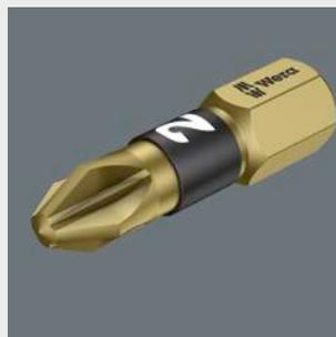
Насадки ВТН и ВТЗ имеют отожженную зону BiTorsion, с помощью которой твердость тела снижена примерно на 20 % по сравнению с ведомым наконечником. Это позволяет дополнительно избежать скручивания острия насадки при наступающих пиках нагрузки, что еще больше продлевает срок службы насадки.
