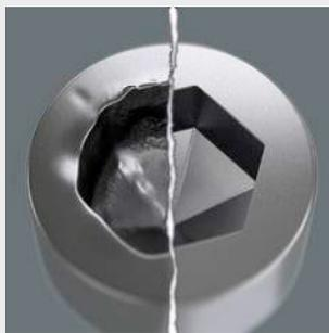
Проблема винтов с внутренним шестигранником Нех-Plus заключается в том, что этот профиль быстро скругляется. Причина этого связана с воздействием острых граней инструмента на внутреннюю поверхность головки винта. Процесс постепенного износа в итоге приводит к скруглению профиля. Инструменты
