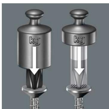
Wera Lasertip уменьшает необходимое усилие прижима и повышает передачу момента силы. Завинчивание становится более безопасным и удобным.
