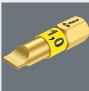
относятся к абсолютному премиум-классу. С помощью мягкой зоны Bitorsion твердость тела снижена примерно на 20 % по сравнению с твердостью наконечника. Это позволяет в большинстве случаев избежать скручивания наконечника бита при наступающих пиках нагрузки, что в значительно продлевает срок службы бита.
