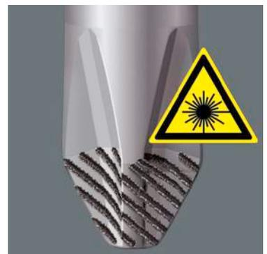
Узко сфокусированный луч лазера создает структуру поверхности с острыми кромками. Твердость профиля после обработки лазером составляет до 1000 HV. Наконечник Wera Lasertip крепко „цепляется“ за шлиц винта и предотвращает выскальзывание из него. Идеален для прямого шлица, Phillips и Pozidriv.
