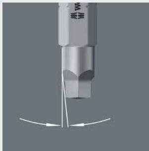
Насадки V характеризуются коническим профилем. Возникающая за счёт этого прижимная сила надежно удерживает винты Робертсона на конце инструмента. Идеальное решение при завинчивании в труднодоступном месте.
