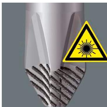
При обработке наконечника лазером образуется микрошероховатая поверхность с твердостью кромок до 1000 HV. Она прочно сцепляется с головкой винта. Преимущества: меньше выскальзываний, выше безопасность.
