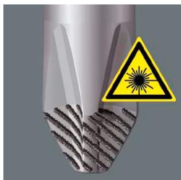
Узко сфокусированный луч лазера создает структуру поверхности с острыми кромками. Твердость профиля после обработки лазером составляет до 1000 HV. Наконечник Wera Lasertip крепко „цепляется“ за шлиц винта и предотвращает выскальзывание из него. Идеален для прямого шлица, Phillips и Pozidriv.
