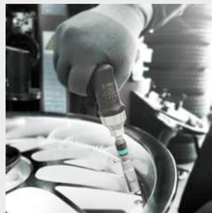
Для таких ведущих производителей систем, как Alligator, Beru, CUB, Herth & Buss, Schrader, VDO/Conti. Включает динамометрические инструменты с регулировкой и уставкой, завертки и фиксаторы для вентилях с цветовой кодировкой. В практическом органайзере с твердым вкладышем.
