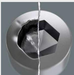
Проблема винтов с внутренним шестигранником Hex-Plus заключается в том, что этот профиль быстро скругляется. Причина этого связана с воздействием острых граней инструмента на внутреннюю поверхность головки винта. Процесс постепенного износа в итоге приводит к скруглению профиля. Инструменты
