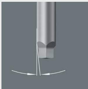
Насадки V характеризуются коническим профилем. Возникающая за счёт этого прижимная сила надёжно удерживает винты Робертсона на конце инструмента. Идеальное решение при завинчивании в труднодоступном месте.
