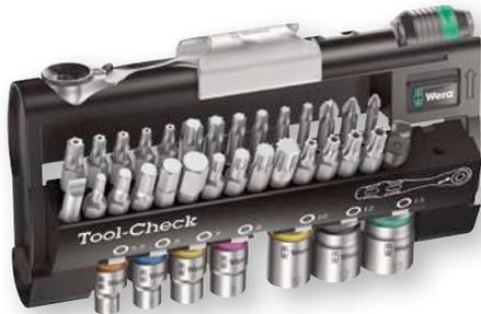
28 битов, 7 насадок для ручного и машинного режима работы, адаптер Rapidaptor: 1 шт., адаптер 870/1 (для перехода с шестигранника 1/4" на квадрат 1/4"); 1 шт., трещотка Wera, ковкая стальная конструкция подходит для насадок с шестигранным хвостовиком 1/4" по стандарту DIN ISO 1173-C 6,3 и E 6,3, а также с типом хвостовика Wera 1 и 4; с применением адаптера Wera 870/1 возможно также использование головок 1/4"
