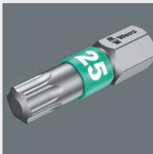
С помощью мягкой зоны Bitorsion твердость тела снижена примерно на 20 % по сравнению с твердостью наконечника. Это позволяет в большинстве случаев избежать скручивания наконечника бита при наступающих пиках нагрузки, что в значительно продлевает срок службы бита.
