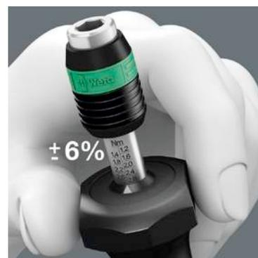
Погрешность  $\pm 6\%$  по стандарту DIN EN ISO 6789. Слышимый и ощущаемый щелчок по достижении установленного крутящего момента.
