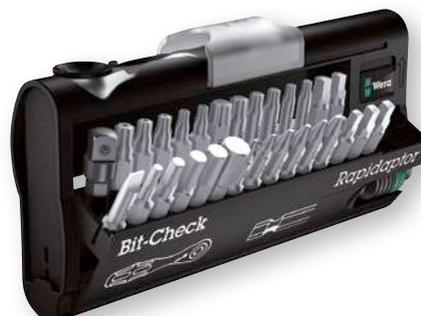
28 насадок, 1 держатель Rapidaptor, 1 адаптер 870/1 (для перехода с шестигранника 1/4" на четырехгранник 1/4"). 1 трещотка для битов Wera, кованная стальная конструкция; подходит для насадок с шестигранным хвостовиком 1/4" по стандарту DIN ISO 1173-C 6,3 и E 6,3, а также с типом хвостовика Wera 1 и 4; с применением адаптера Wera 870/1 возможно также использование головок 1/4"
