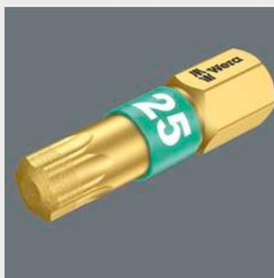
это насадки премиум-класса. С мягкой зоной BiTorsion, с помощью которой твердость тела по сравнению с твердостью ведомого наконечника снижена примерно на 20 %. Это позволяет избежать большинства случаев скручивания острия насадки при наступающих пиках нагрузки, что еще больше продлевает срок
