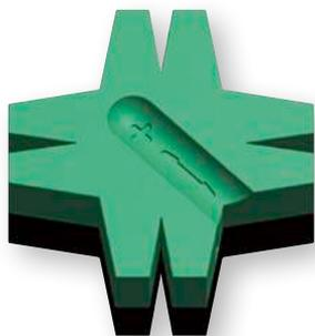
**Применение:** Просто провести отверткой вдоль выемки с положительным зарядом приспособления Wera. Теперь инструмент будет прочно удерживать винт. Для размагничивания инструмент следует провести вдоль одной из четырех сторон с отрицательным зарядом.
