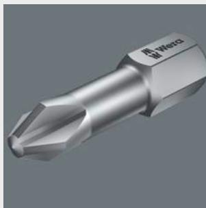
Насадки TZ – это насадки Z с зоной кручения. Насадки Torsion обеспечивают амортизацию пиков крутящего момента в зоне кручения. Это позволяет избежать преждевременного износа и продлить срок службы насадки.
