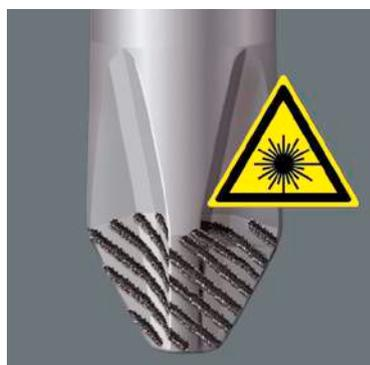
Узко сфокусированный луч лазера создает структуру поверхности с острыми кромками. Твердость профиля после обработки лазером составляет до 1000 HV. Наконечник Wera Lasertip крепко «цепляется» за шлиц винта и предотвращает выскользывание из него. Идеален для прямого шлица, Phillips и Pozidriv.
