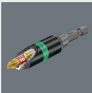
Быстросменный держатель Rapidaptor BiTorsion пригоден для насадок 1/4" по стандарту DIN ISO 1173-C 6,3 (тип хвостовика Wera 1), и E 6,3 (тип хвостовика Wera 4). У держателей BiTorsion от компании Wera имеется торсионная пружина, которая амортизирует небольшие пики нагрузки при завинчивании. Совместное использование с насадкой BiTorsion и ее торсионной зоной значительно увеличивает срок службы инструмента. Держатели BiTorsion от компании Wera могут также применяться с обычными насадками.
