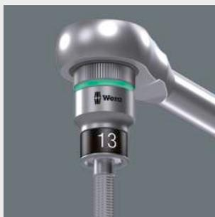
Фиксация шестигранного винта в торцевой головке обеспечивается двумя шариковыми фиксаторами и высокопрочным эластичным воротником. От механического повреждения его защищает стальной буртик, расположенный спереди. Они особенно помогают при работе в труднодоступном месте, куда для поддержки винта не помещается вторая рука.
