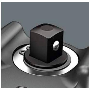
Смена вращения с помощью сдвижного квадрата гарантирует необычайно высокую нагрузочную способность, так как при ударах молотком переключающая механика не подвергается разрушению.
