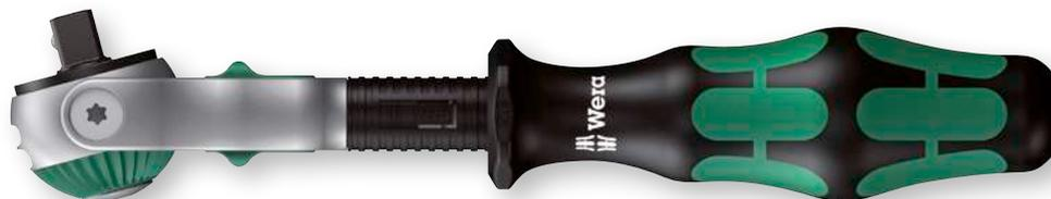
Головка трещотки свободно поворачивается и благодаря расположенным с обеих сторон сдвижным переключателям может блокироваться в любом положении. Таким образом, даже в узких и труднодоступных местах Вы можете выполнять работы без проблем и достаточно свободно. Фиксация в определенных положениях под углом 0°, 15° и 90° влево и вправо гарантирует уверенную работу с надежно зафиксированной трещоточной головкой.
