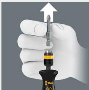
Для смены насадки необходимо просто сдвинуть втулку вперед: При этом пружинный механизм приподнимет насадку с магнита и разблокирует инструмент. Насадка может быть легко извлечена. Отличная помощь: Легкое извлечение даже минимальных размеров насадок без вспомогательного инструмента.
