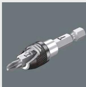
Быстрозажимной держатель обеспечивает прочное и стабильное соединение с насадкой, которое можно легко нейтрализовать. Держатель сконструирован таким образом, что для замены бита нужно просто сдвинуть внешнюю гильзу вперед, чтобы легко установить и извлечь насадку.
