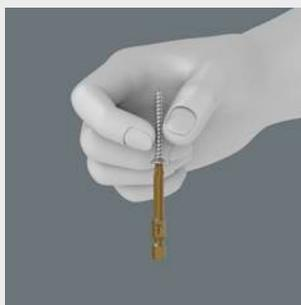
В труднодоступных местах (например, в моторном отсеке) невозможно зафиксировать рукой винт на отвертке. Часто винт куда-то падает. Затем следует утомительный поиск или потеря винта (и, возможно, связанные с этим риски). Разработанные фирмой Wera инструменты TORX® HF улучшают геометрию профиля TORX®. Благодаря силе прижима, создаваемой поверхностным напряжением между профилем винта и наконечником, винт надежно удерживаются на инструменте!
