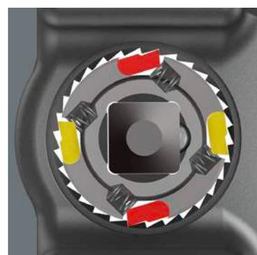
Благодаря двойному храповому механизму 30 прочных зубцов действуют как тонкий механизм из 60 мелких зубцов с углом возврата всего  $6^\circ$
