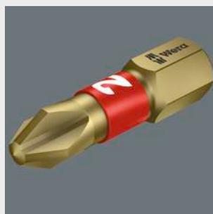
Насадки ВТН имеют отожженную зону Bitorsion, с помощью которой твердость тела снижена примерно на 20 % по сравнению с ведомым наконечником. Это позволяет дополнительно избежать скручивания острия насадки при наступающих пиках нагрузки, что еще больше продлевает срок службы насадки.
