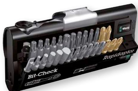
28 насадок, 1 держатель Rapidaptor, 1 адаптер 870/1 (для перехода с шестигранника 1/4" на четырехгранник 1/4"). 1 трещотка для битов Wera, кованная стальная конструкция; подходит для насадок с шестигранным хвостовиком 1/4" по стандарту DIN ISO 1173-C 6,3 и E 6,3, а также с типом хвостовика Wera 1 и 4; с применением адаптера Wera 870/1 возможно также использование головок 1/4"
