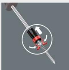
Подтянуть фиксатор к ручке отвертки так, чтобы лапки захвата враспор прилегли к головке винта. После завинчивания фиксатор Wera освобождает винт автоматически!
