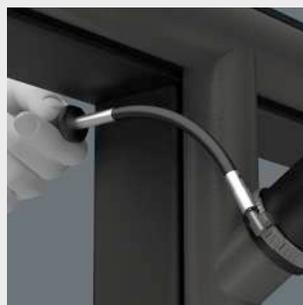
Используя отвертку 391, можно работать также с деталями, находящимися в очень неудобных местах. Гибкий стержень позволяет добраться до крепежа, расположенного под углом. Идеальный инструмент для выполнения работ с деталями на винтовом соединении в труднодоступных местах, например, в моторном отсеке.
