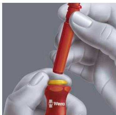
Наборы Kraftform Kompakt VDE включают в себя изолированную ручку, а также изолированные сменные рабочие концы для замены без использования специальных инструментов.
