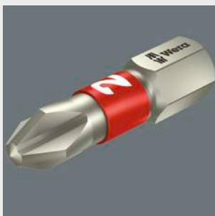
Благодаря применению насадок из нержавеющей стали предотвращается возникновение ржавчины на винтах или поверхностях из нержавеющей стали. Контактная ржавчина на нержавеющей стали появляется, прежде всего, за счет использования при завинчивании обычных стальных инструментов.
