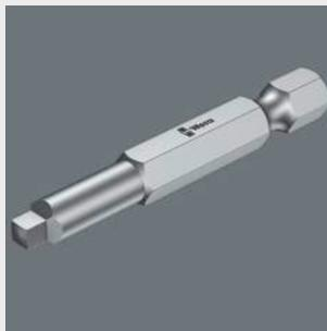
С помощью мягкой зоны Bitorsion твёрдость тела снижена примерно на 20 % по сравнению с твердостью наконечника. Это позволяет в большинстве случаев избежать скручивания наконечника бита при наступающих пиках нагрузки, что в значительно продлевает срок службы бита.
