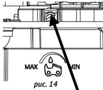
Объём подачи масла можно отрегулировать болтом в нижней части пилы как на рис.13-14
