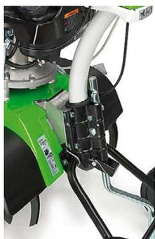
**Мощная встроенная в крепление ручки антивибрационная система** облегчает длительную работу и снижает напряжение суставов. Удобное ведение устройства с меньшей затратой усилий.
