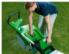
**Удобство в эксплуатации:** травосборник оснащен двумя прочными креплениями для удобного и надежного монтажа/демонтажа травосборника на газонокосилке.
