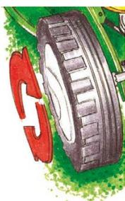
**Привод передних колес:** экономит энергию при кошении и мульчировании. Во время разворота при активированном приводе газонокосилка без усилий поворачивается на 180 градусов благодаря задним колесам.
