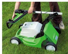
**Экономия места:** рукоятка газонокосилки складывается вперед на время хранения и транспортировки. В результате газонокосилка становится очень компактной.
