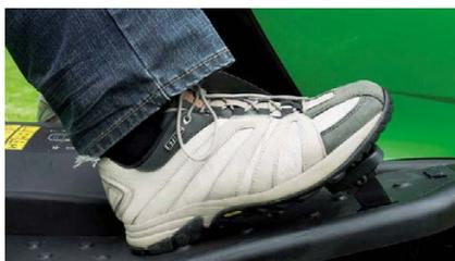
Удобство как на автомобиле с автоматической коробкой передач: **гидростатический привод движения** для плавной регулировки скорости.
