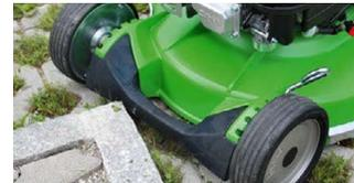
**Бампер из резины:** фронтальный бампер защищает устройство и препятствия от наезда, может также использоваться в качестве ручки для транспортировки.
