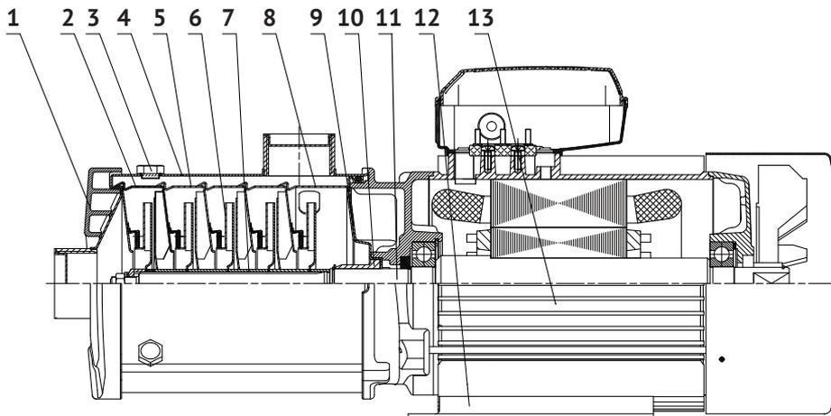
Рисунок 10 – Конструкция насоса
