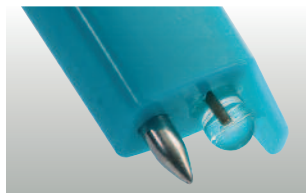
testo 206-pH1: наконечник зонда pH1 для жидкостей
