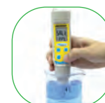
Шаг 3: Нажмите кнопку "MODE/ENT", чтобы перейти к измерению другого параметра
