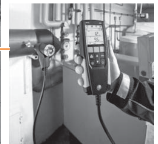
Анализ дымовых газов с помощью газоанализаторов testo 310/320/330-1LL/330-2LL
