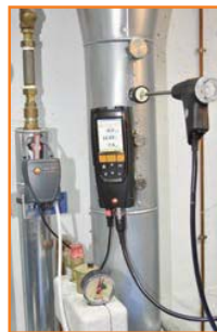
Одновременное измерение дымовых газов и дифференциального давления с помощью высокоточного зонда давления.
