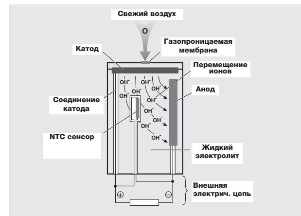
Рис. 27: Принцип работы сенсора O_2
