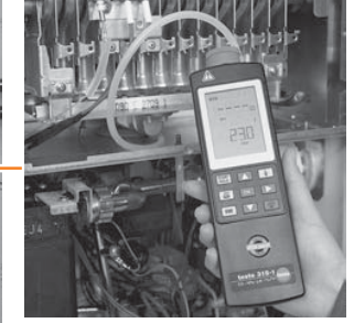
Испытание на герметичность манометром testo 312-2
