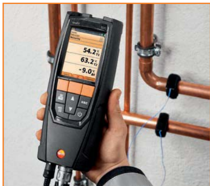
Измерение дифференциальной температуры с помощью зонда-обкрутки.
