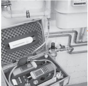
Проведение предварительного теста с использованием прибора testo 312-3
