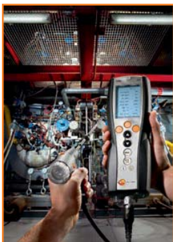
Рис. 19: Testo 340: многокомпонентный анализатор дымовых газов с возможностью прямого измерения NO x
