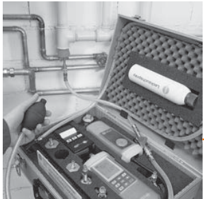
Проведение основного теста с использованием прибора testo 312-2/3
