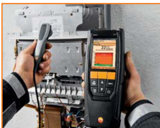
Измерение концентрации CO в окружающей среде.
