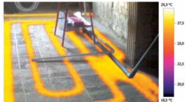
Визуализация скрытых трубопроводов на реальном снимке, с помощью TwinPix
