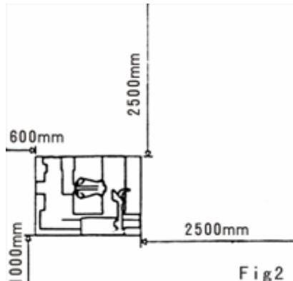
Выбирайте место установки согласно следующим правилам безопасности в процессе работы. Станок должен быть подключен к источнику питания. Таким образом, необходимо устанавливать оборудование вместе с имеющимся разъемом для подключения к сети. Площадь рабочей зоны должна быть такой, чтобы оператор мог выполнять работу с устройством без каких-либо ограничений (рис. 2).
