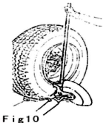
(7) Вращайте колесо против часовой стрелки, чтобы полностью снять внешний борт шины с колеса (рис. 11).
