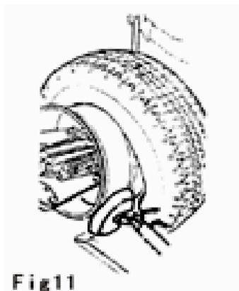
(8) Переведите рукоятку инструментальной консоли к внутренней части шины, установите диск рядом с бортом, вращайте колесо против часовой стрелки, чтобы полностью снять внутренний борт шины с колеса (рис. 12).
