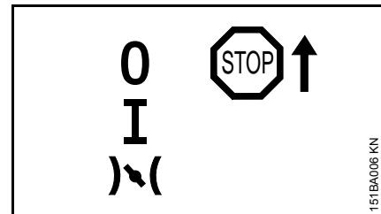
**Stop 0 – Двигатель остановлен – Зажигание выключено**
