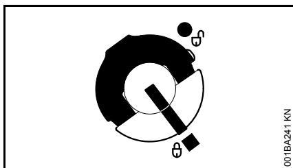
Крышка бака зафиксирована
