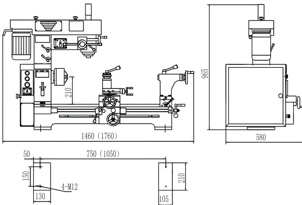
Размер крепежного отверстия станины
