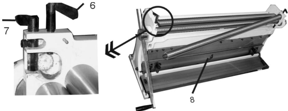
Для снятия свёрнутой в трубу детали нужно открутить стопор (6) с двух сторон верхнего ролика и освободить фиксатор (7), повернув его на 90°. Вынуть верхний ролик и снять обработанную деталь.
