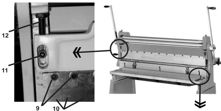
Для того чтобы установить пуансоны (10) в одной плоскости, их нужно снять, открутив болты (9) на прижимной планке удерживающей пуансоны. Снять прижимную планку и пуансоны, промыть посадочные места и все детали гибочного механизма керосином или уайтспиритом. Установить пуансоны и прижимную планку на место. При не плоскостности рабочей поверхности пуансонов больше 0.1 мм, на посадочные места, под пуансоны необходимо подложить фольгу для выравнивания пуансонов.
