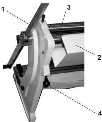
Свёртывающий механизм станка SNO – в специальной подналадке не нуждается, однако во время работы необходимо следить за параллельностью перемещения валков относительно друг друга. Для этого винты (4) подачи заднего ролика (3) отпускать и прижимать нужно на равное количество оборотов.
