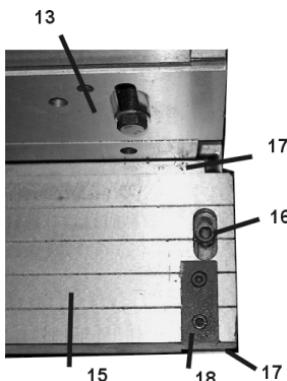
Величина зазора между ножами ножниц регулируется за счёт смещения стола (15) на котором крепится нижний нож ножниц. Для регулировки зазора между ножами ножниц нужно отпустить болты (16) с обеих сторон стола и с помощью ..... (17) установленных под ..... (18) установить стол в требуемое положение.
