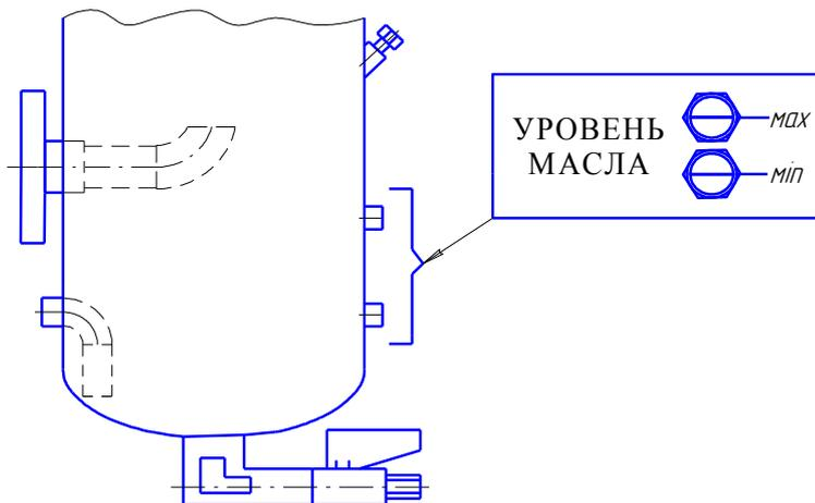
Примечание: Оптимальная температура окружающей среды для контроля граничных значений (max и min) уровня масла равна  $20 \pm 5^\circ\text{C}$ .
