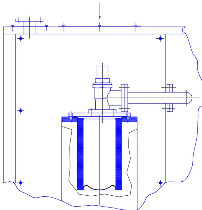
**ВНИМАНИЕ:** ПРИ СНЯТИИ КРЫШКИ НЕ ПОВРЕДИТЕ ТРУБКУ ОТВОДА МАСЛА ИЗ КАРТРИДЖА (УСТАНОВЛЕНА НА ВНУТРЕННЕЙ СТОРОНЕ КРЫШКИ).
