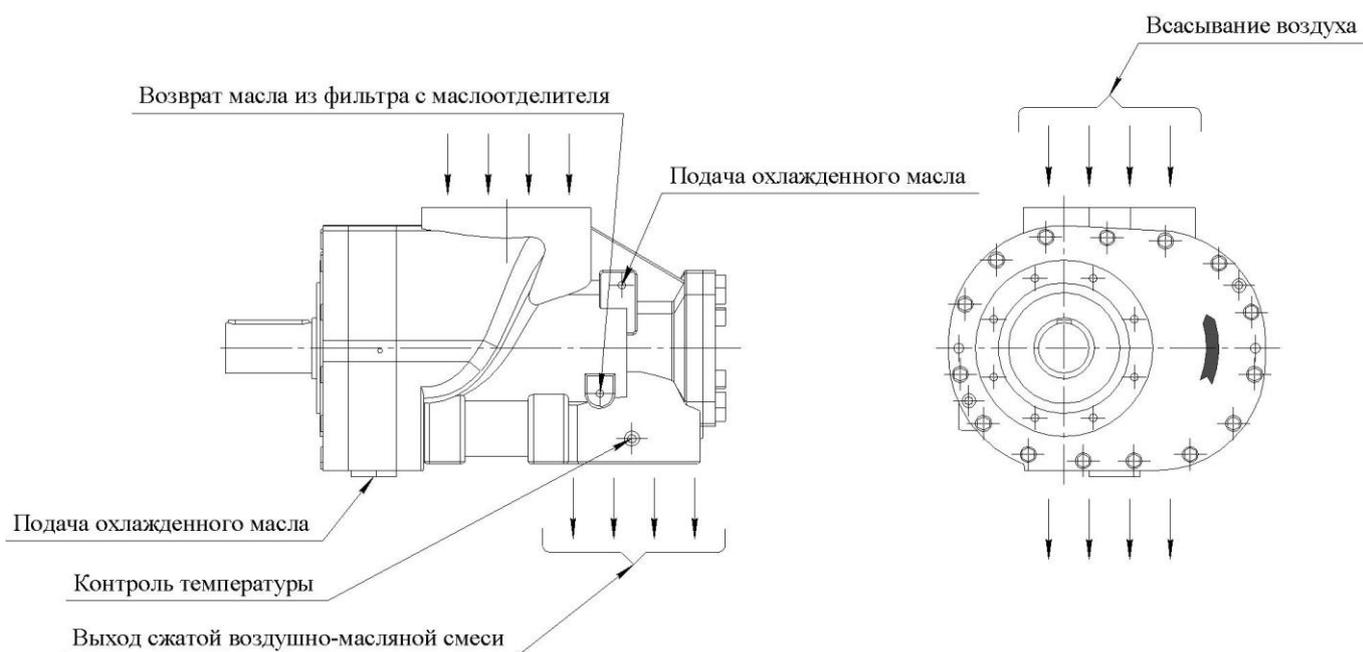
**ВНИМАНИЕ: НАПРАВЛЕНИЕ ВРАЩЕНИЯ ВАЛА ВИНТОВОЙ ГРУППЫ УКАЗЫВАЕТ СТРЕЛКА, РАСПОЛОЖЕННАЯ НА ВИНТОВОМ БЛОКЕ СО СТОРОНЫ ТОРЦА ВАЛА.**
