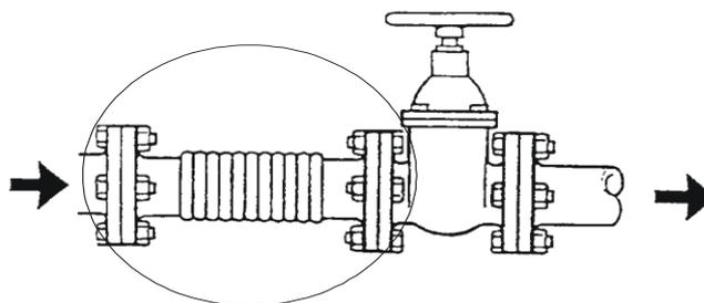
Перед пуском отсекающий кран обязательно должен быть открытым. Трубопроводы следует укладывать с уклоном 0,005 в сторону линейных влагоотделителей.
