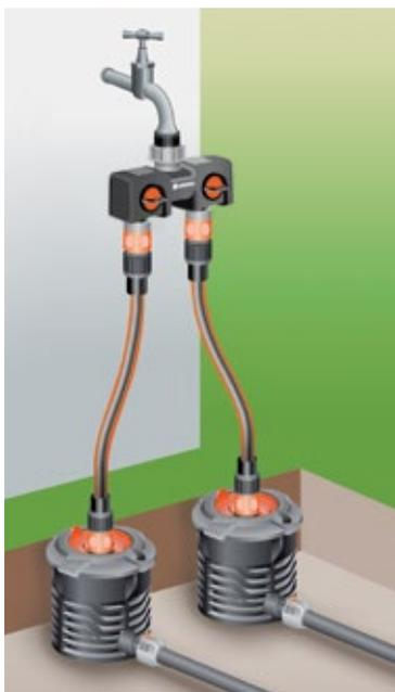
К водопроводному крану можно подсоединить 2 подающих трубопровода с использованием 2-канального распределителя (арт. 08193-20.000.00).
