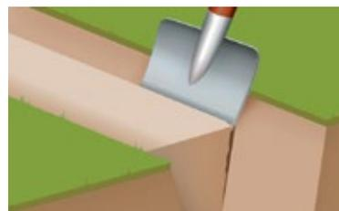
Прорежьте лопатой в газоне V-образные канавки глубиной примерно 20 см. Осторожно удалите дерн, камни и лишний грунт из канавок.
