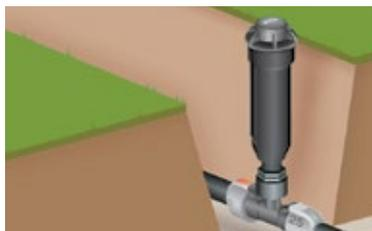
Уложите в канавки трубопроводы с дождевателями. Чтобы предотвратить повреждение деталей системы полива, например, при стрижке газона, все дождеватели и колонки лучше установить немного ниже уровня земли, чтобы учесть усадку грунта.
