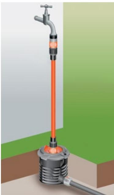
Для подключения к водопроводному крану используется входная колонка (арт. 02722-20.000.00), соединительный комплект системы "Профи" (арт. 01505-27.000.00) и любой садовый шланг 19 мм (3/4").
