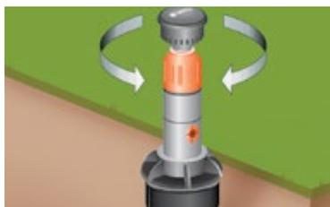
Установите на дождевателях направление, сектор и дальность полива. Обязательно проведите пробный запуск системы до ее прокладки под землю.
