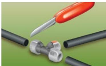
Разрежьте магистральные шланги (трубопроводы) на отрезки нужной длины и подсоедините к трубам соответствующие фитинги. Убедитесь, что на концы трубопроводов не попала земля.
