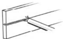
Рисунок 18. Горизонтальное положение при сварке
