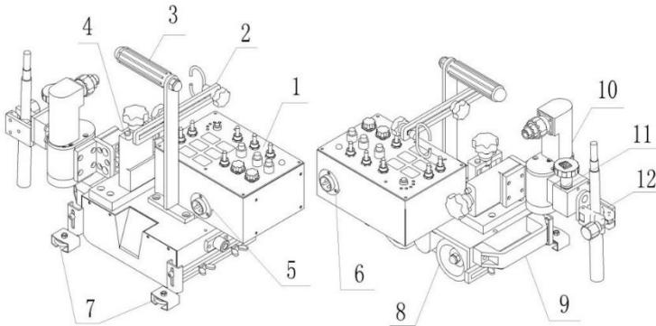
Установка КЕДР СК-5 состоит из корпуса каретки, роликовых упоров, ручки для переноски, блока корректировки положения каретки, осциллятора горелки и панели управления.
