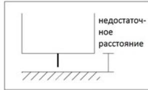
эффект: обзор мундштука закрыт, плохой обзор присадки, чрезмерная глубина проплавления
