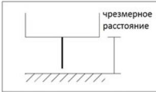
эффект: сварочные раковины, сложность возбуждения дуги, нестабильность дуги, недостаточная глубина проплавления
