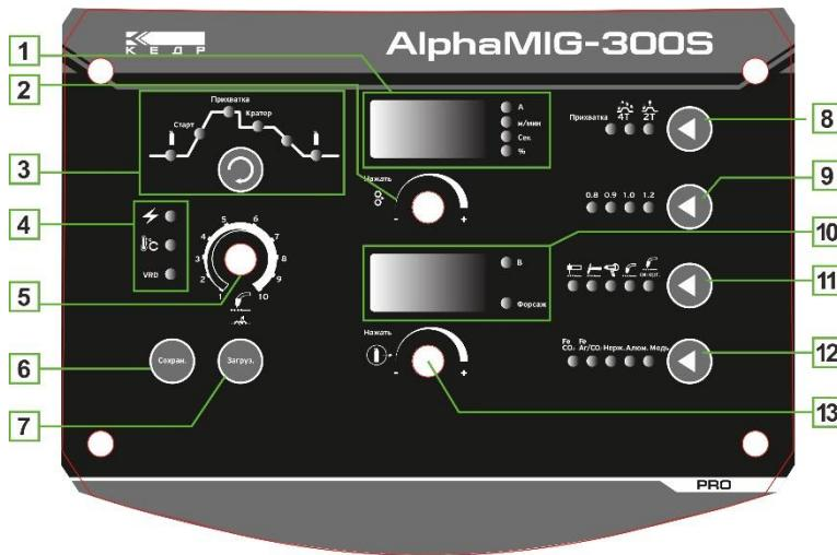
1. Дисплей 1: отображение параметров: сварочный ток, скорость подачи проволоки, время, проценты.
