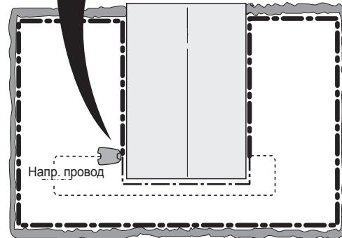
4. а) Предположим, что контрольная лампа горит зеленым светом в процессе выполнения теста За). Верните все соединения в исходное положение. Теперь разъедините соединение AR. Подсоедините к AR новый контурный провод. Другой конец этого нового контурного провода подсоедините где-нибудь в середине участка.
