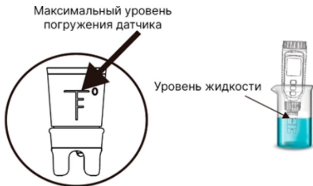
Рисунок 6 - Корректное размещение анализатора в исследуемой жидкости
