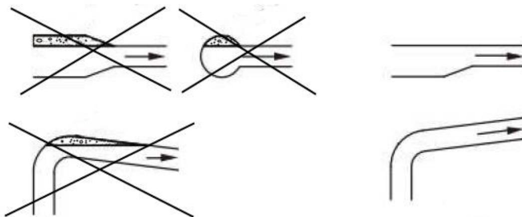
В случае, если напорный трубопровод направлен сверху вниз от насоса или имеет вертикальные изгибы в виде колена, где возможно образование сифона, необходимо установить воздухоотводный клапан в ближайшей к насосу точке.
