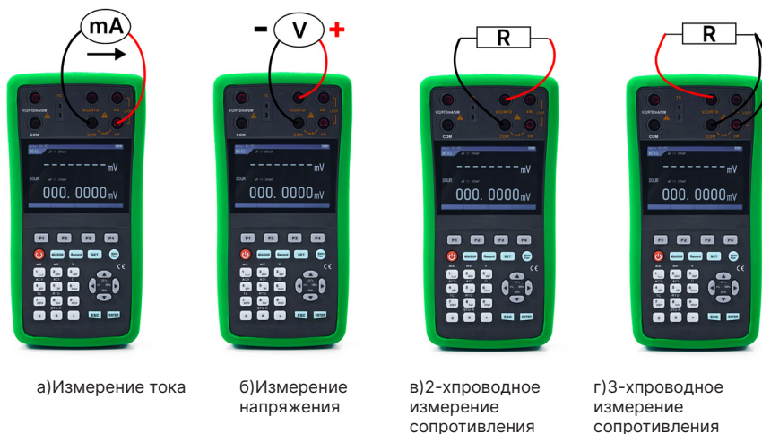
Рисунок 4 - Схемы подключения прибора в режиме измерения
