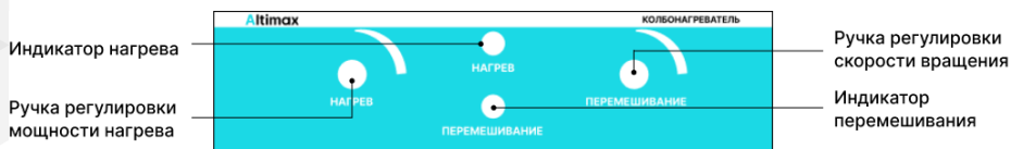
Рисунок 6 – Элементы управления Altimax НМС-1.
