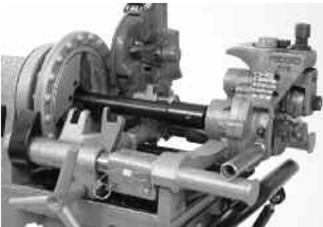
Figur 6 – 975 Combo Roll Groover korrekt montert på 300 Compact Threading Machine
