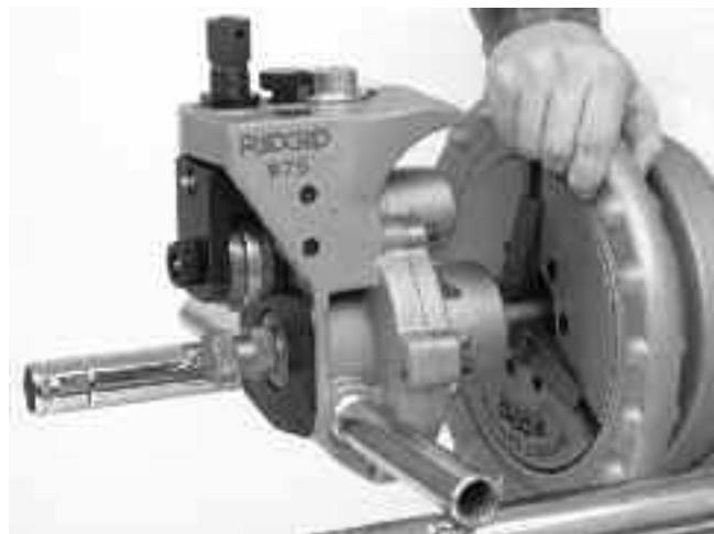
3. ábra: A 975-ös kombinált görgős csőhornyoló rögzítése a 300-as gépi hajtás befogójába
