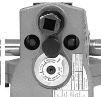
Figura 15B – Indicador en posición de ranurado
