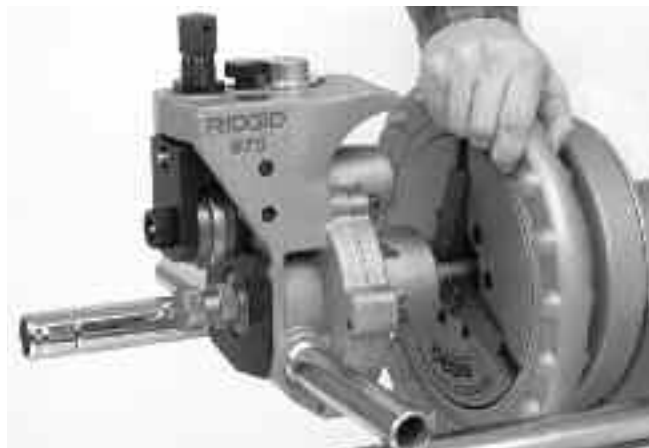
Ilustracja 3 – Montaż rowkarki rolkowej 975 Combo Roll w uchwycie 300 Power Drive
