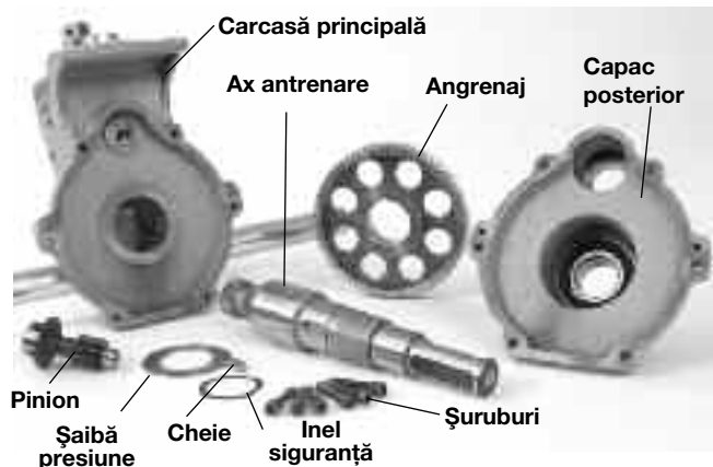
Figura 20 – Diagrama pieselor pentru dispozitivul 975 combo pentru roluit caneluri
