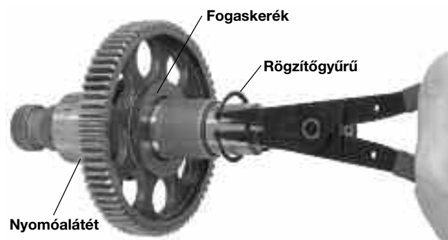
19. ábra: A rögzítőgyűrű eltávolítása
