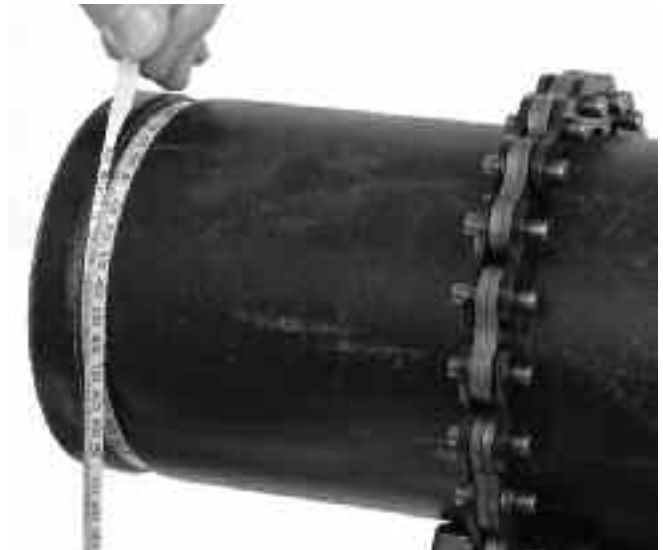
Figuur 16 – Controleren van de groefdiameter met een diametermeetband
