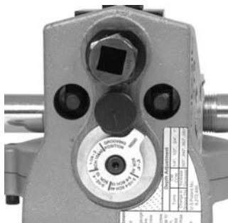
Figura 10B – Indicador en posición de ranurado
