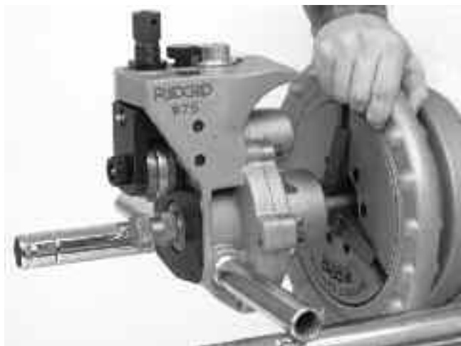
Slika 3. – Postavljanje kombiniranog alata za izradu spojnica na cijevima na držač pogonskog sklopa 300
