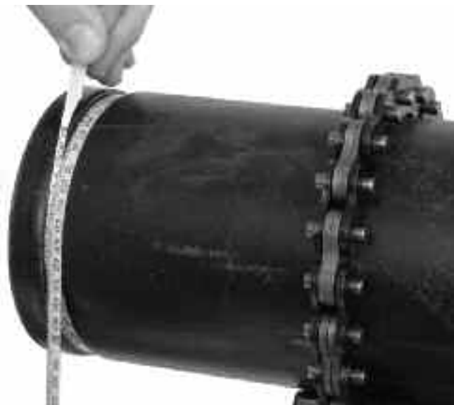
Figura 11 – Verificar o diâmetro do sulco com uma fita de diâmetro
