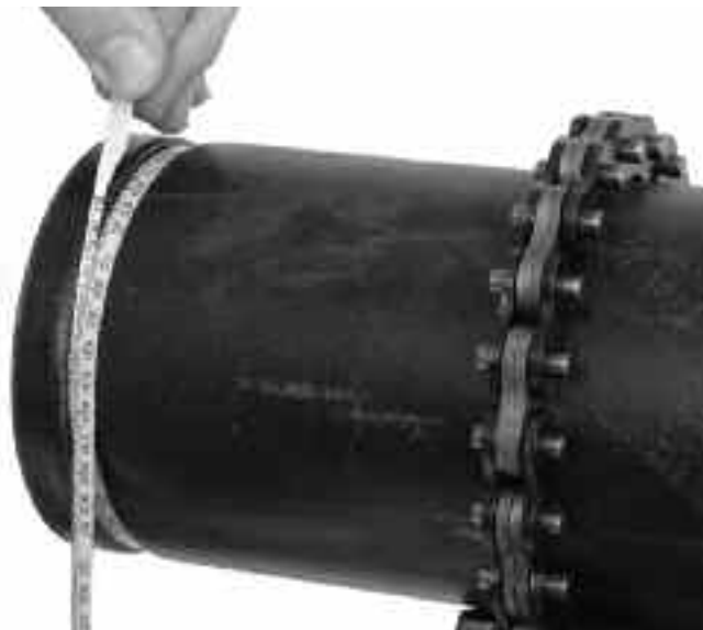
slika 11 – provjera dijametara žljeba pomoću vrpce za mjerenje dijametara
