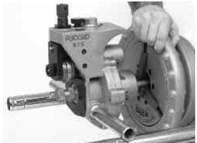
Figur 3. Montering av 975 Combo Roll Groover på 300 Power Drive-chucken
