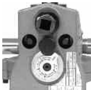
Figura 10B – Calibre na posição de entalhamento
