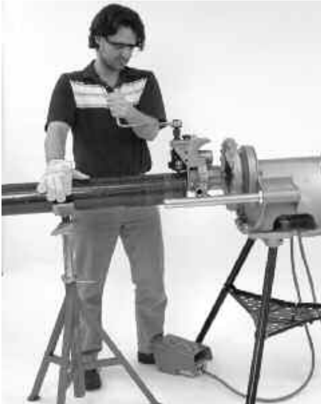
Kuva 13: Putken painaminen urituksen aikana ohjauksen tukemiseksi
