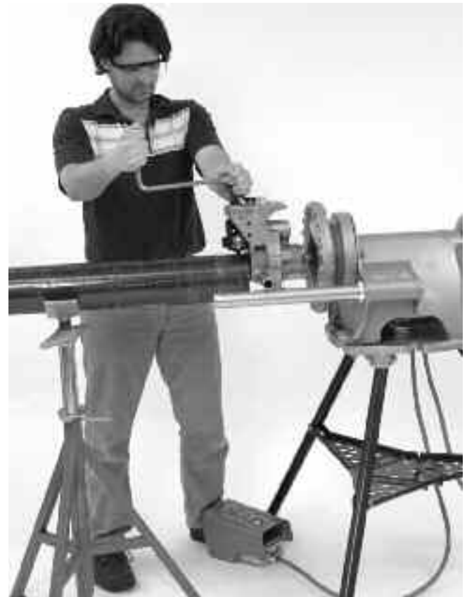
Рисунок 12 – Рабочая позиция устройства для прокатки желобков
