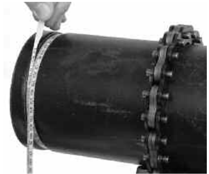
Рисунок 16 – Проверка диаметра желобка с помощью измерительной ленты
