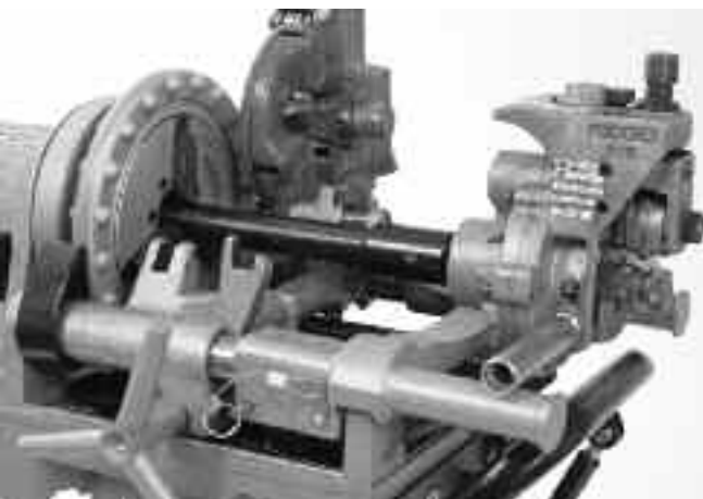
Figur 6 – 975 Combo notsikkemaskinen korrekt monteret på 300 Compact gevindskæremaskine
