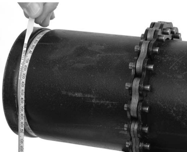
Figure 11 – Vérification du diamètre de rainure à l'aide d'un ruban de circonférence
