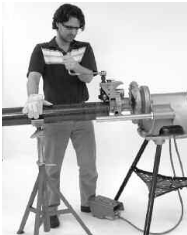
Figura 13 – Apăsarea țevii în timpul canelării, pentru menținerea alinierii
