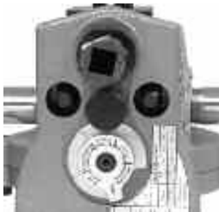
Slika 10A – Stavljanje ispravnog koraka kalibra ispod glave vijka za podešavanje
