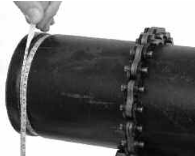
Abbildung 11: Überprüfen des Nutdurchmessers mit einem Durchmesser-Maßband
