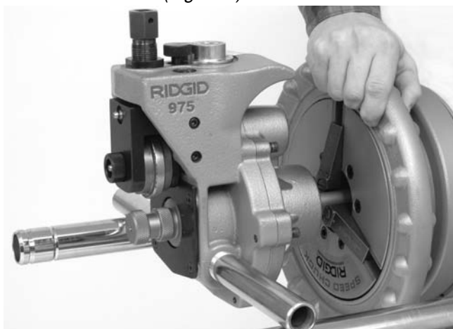
Figura 3 – Montaje de la Ranuradora a Rodillos No. 975 en el portaherramientas del Accionamiento Motorizado No. 300
