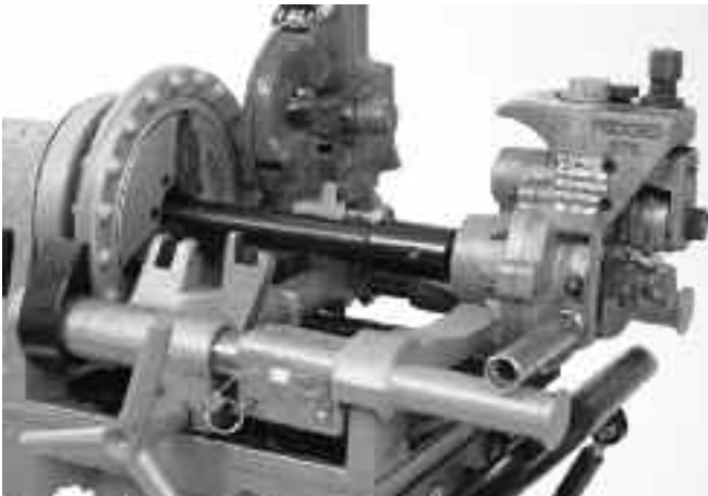
Kuva 6: Oikein 300 Compact Threading Machine -kierteityslaitteeseen asennettu 975 Combo Roll Groover -urituslaite
