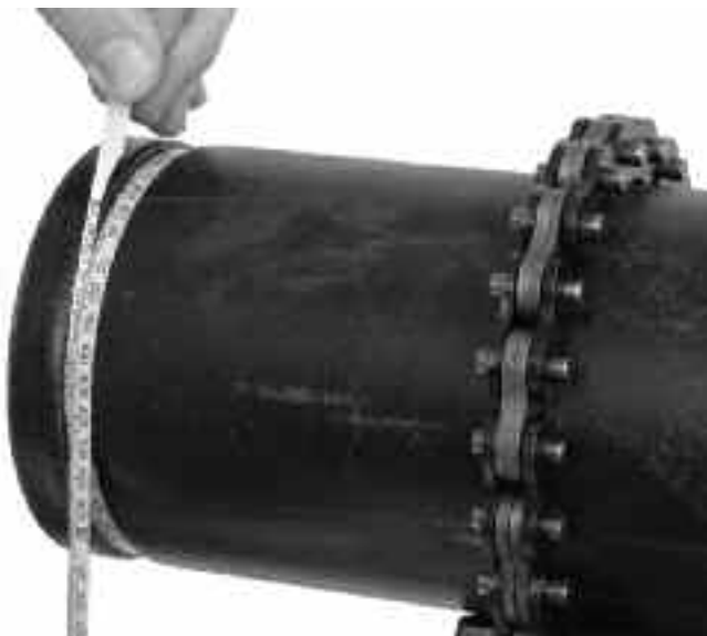
Obrázok 11 – Kontrola priemeru drážky pomocou hrúbkového pásma
