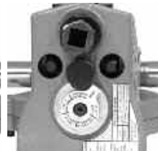
Obrázek 15B – Měřidlo v drážkovací pozici
