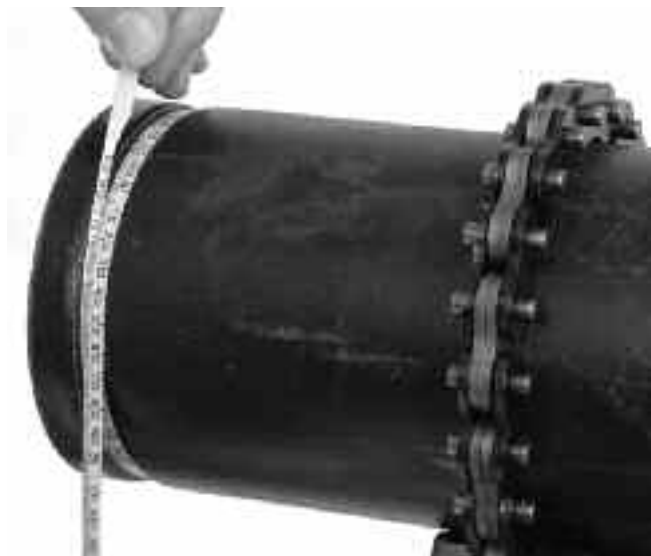
Figura 16 – Medir o diâmetro do sulco com uma fita de diâmetro
