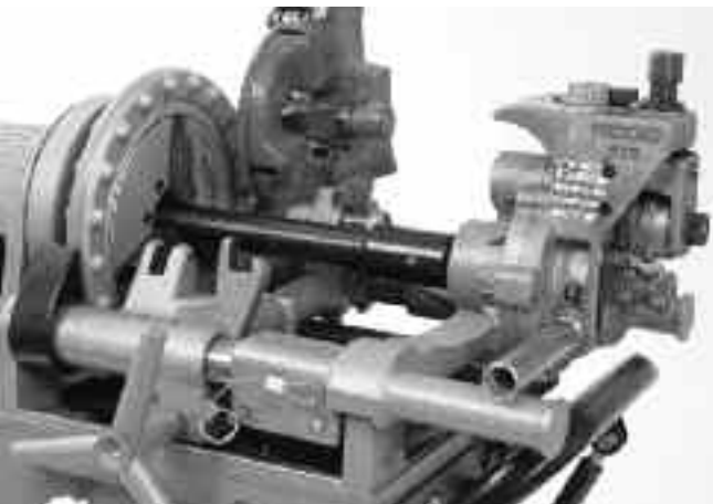
Figura 6 – Dispozitivul 975 combo pentru roluit caneluri montat corect pe dispozitivul compact 300 de filetat
