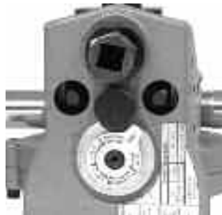
Figura 10B – Misuratore in posizione di scanalatura
