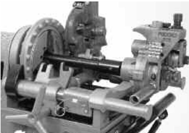
Figura 6 – Entalhadora de rolos 975 Combo correctamente montada na máquina de roscar 300 Compact
