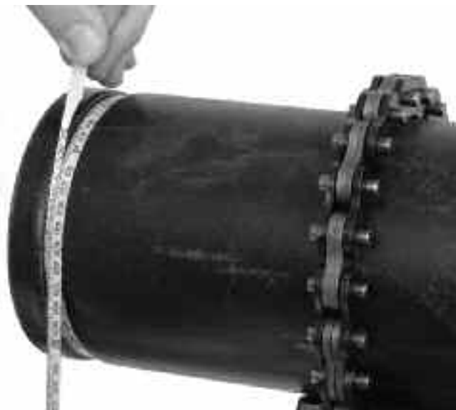
Figuur 11 – Controleren van de groefdiameter met een diametermeetband
