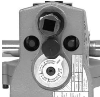
Figure 10B – Jauge en position de rainurage
