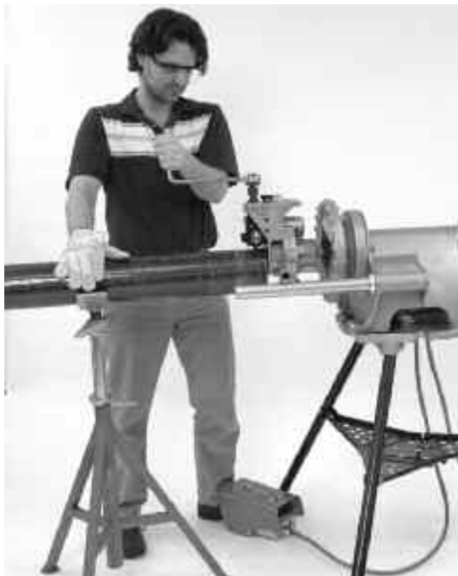
Slika 13 – Pritisk na cev med izdelavo utora, da se ohrani sledenje
