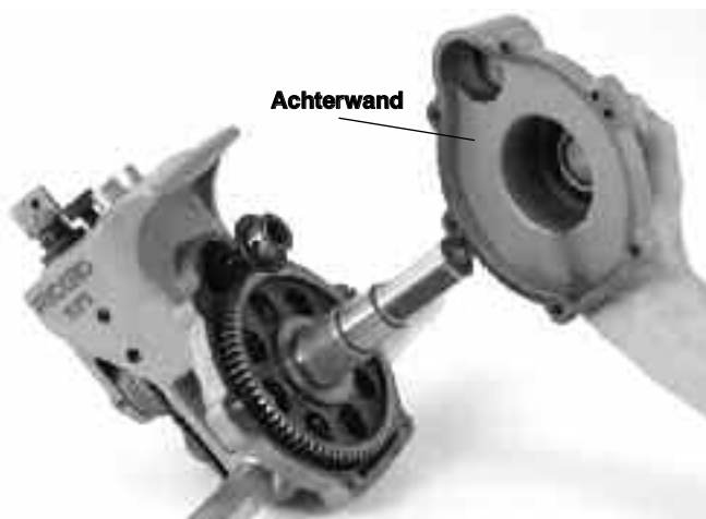
Figuur 18 – Achterwand verwijderen
