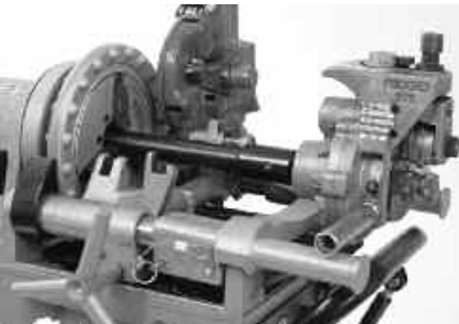
Obrázek 6 – Zařízení 975 Combo Roll Groover správně namontované na závitorezném stroji 300 Compact Threading Machine
