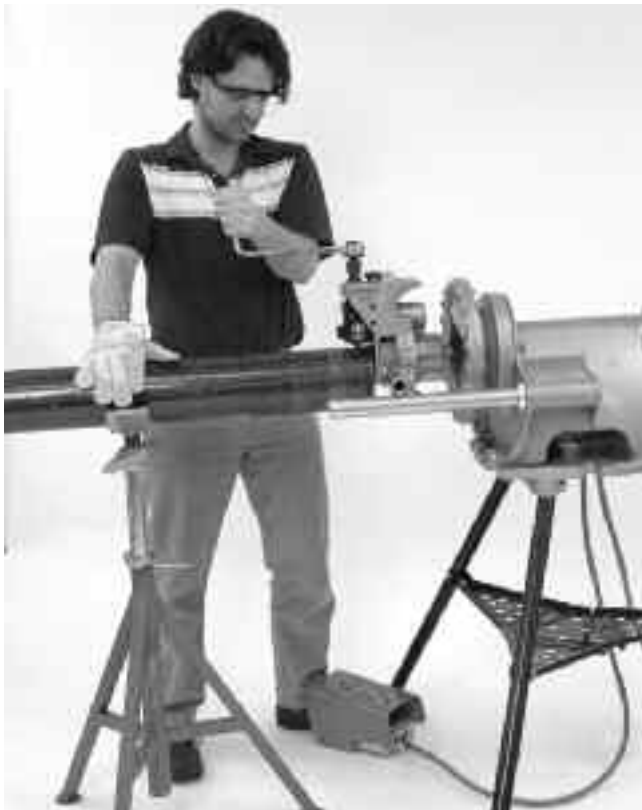
Figur 13. Tryck på röret under rillningen för att upprätthålla spårningskvaliteten
