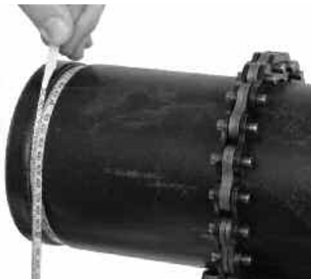
Figur 11 – Kontrollere gjengediameter med et diameter-målebånd
