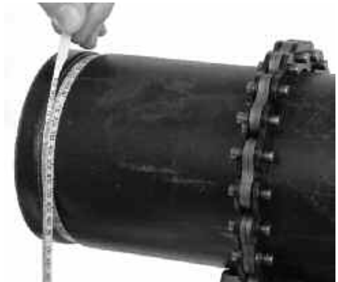
Kuva 16: Uran läpimitan mittaus läpimittanauhalla
