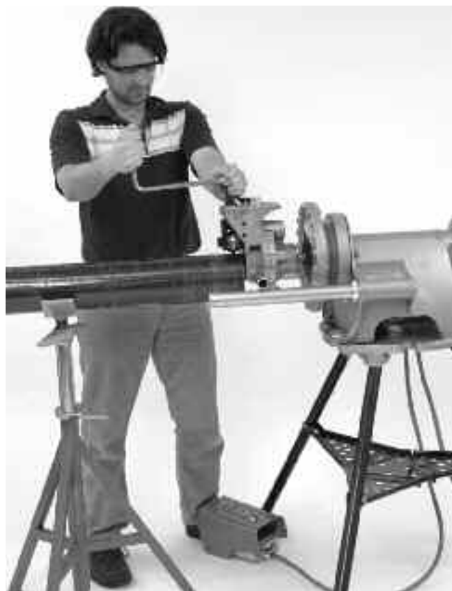
Figura 12 – Posição de operação da entalhadora de rolos
