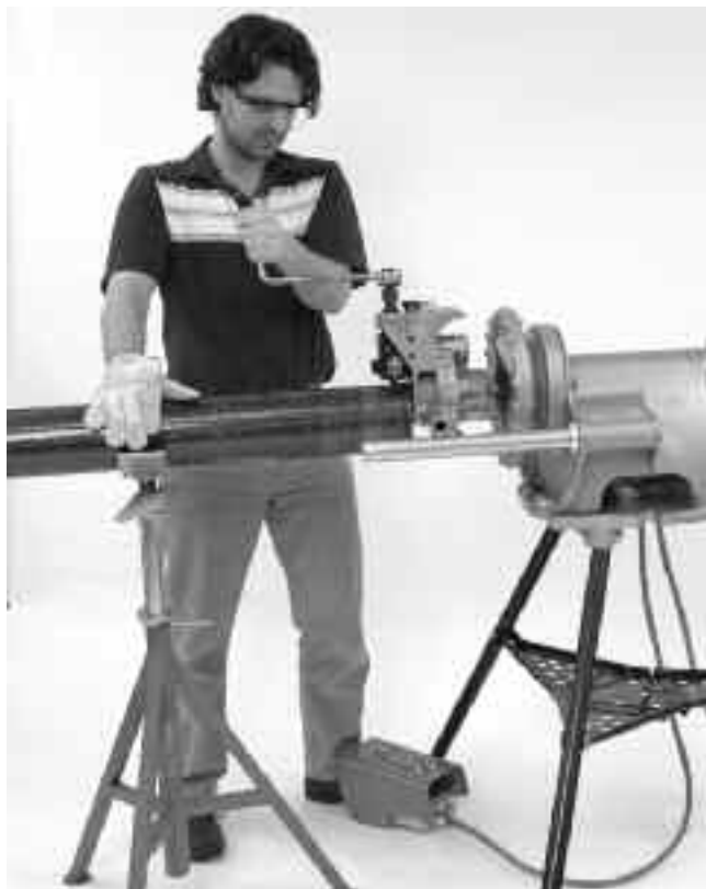
13. ábra: A cső kézzel, kis erővel történő segítése az iránytartásban hornyoláskor
