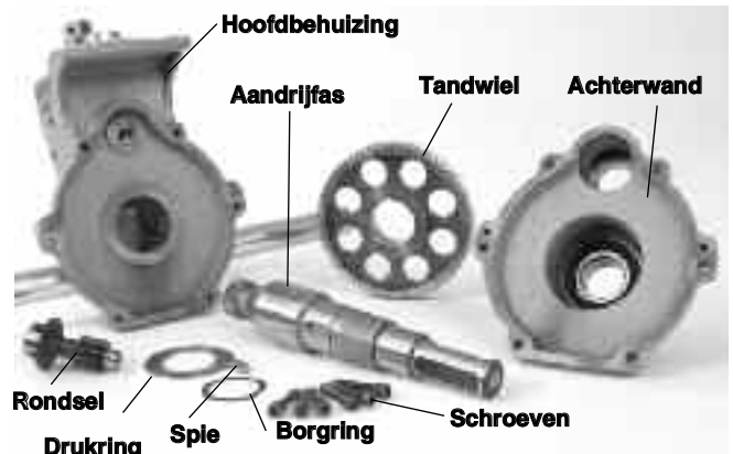
Figuur 20 – Overzicht van de onderdelen van de 975 Combo rolgroever
