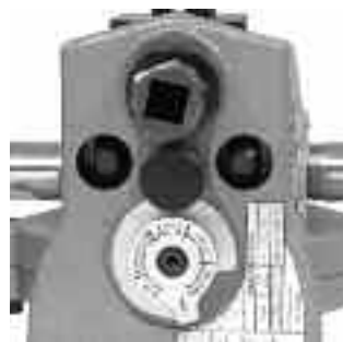
Ilustracja 15A – Ustawić właściwy występ wskaźnika pod łbem śruby regulacyjnej
