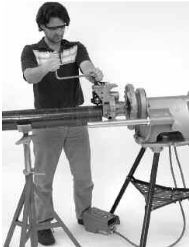
Figura 12 – Poziția de operare a dispozitivului pentru roluit caneluri
