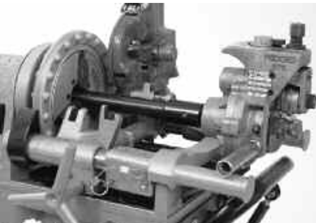
Slika 6 – 975 kombinovana mašina za valjanje žlebova ispravno montirana na 300 kompakt mašinu za narezivanje navoja
