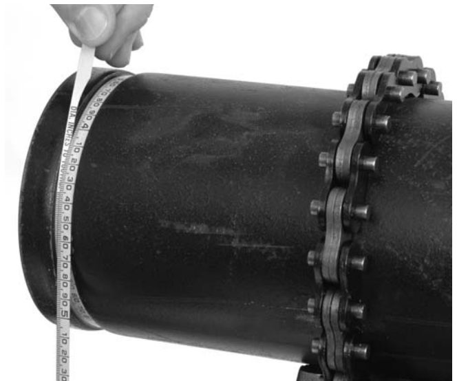
Εικόνα 16 – Μέτρηση της διαμέτρου εγκοπής με ταινία διαμέτρου
