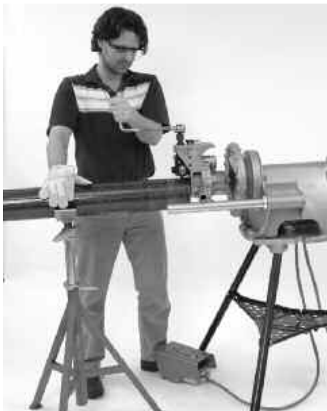
Slika 13 – Primjena sile na cijev prilikom izrade spojnice za održavanje vođenja
