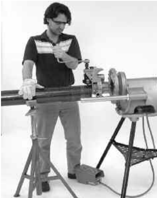
Slika 13 - Primena sile na cev za vreme žlebanja da bi se održalo brazdanje
