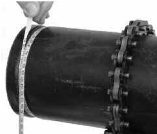
Slika 16 – Merjenje premera utora s tračnim metrom
