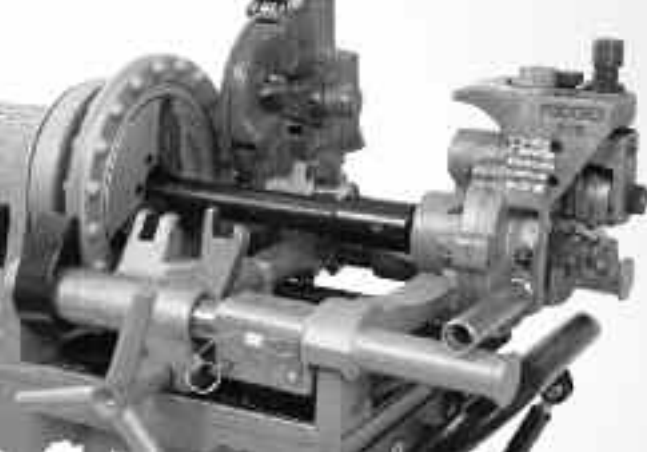
Şekil 6 – 975 Kombo Yiv Açma Aleti'nin 300 Kompakt Dış Açma Makinesi'ne Doğru Şekilde Montajlanmış Hali
