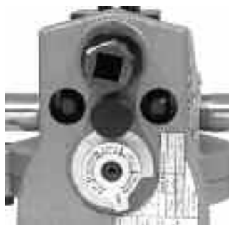
Figur 10A – Placér det korrekte trin på måleren under justeringsskruens hoved
