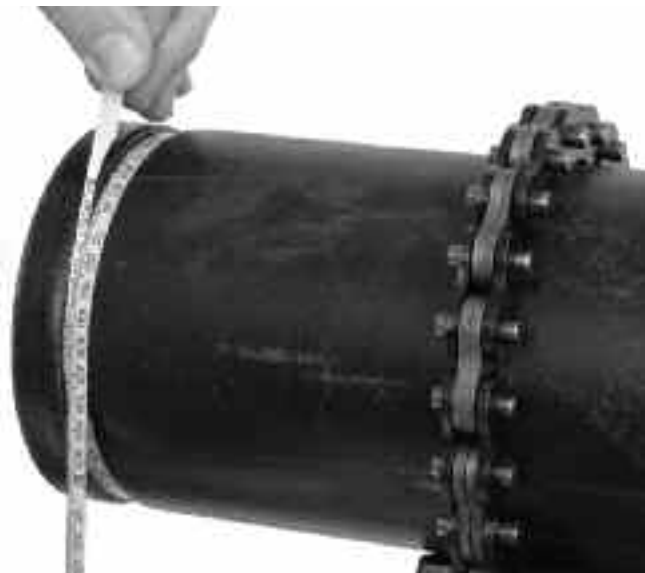
Ilustracja 11 – Sprawdzanie średnicy rowka za pomocą taśmy mierniczej
