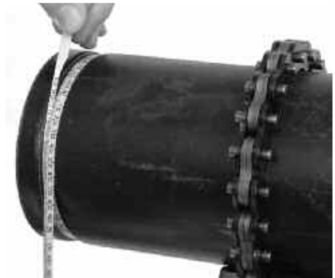
Abbildung 16: Messen des Nutdurchmessers mit einem Durchmesser-Maßband
