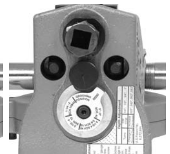
Figure 15B – Jauge en position de rainurage
