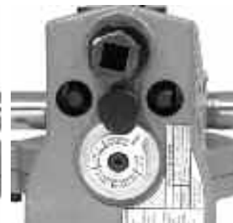
Figura 15B – Misuratore in posizione di scanalatura
