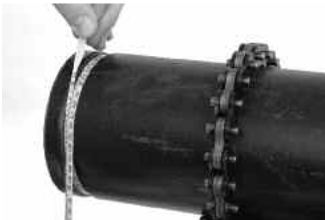
Figura 11 – Verifica del diametro della scanalatura con un nastro per diametri
