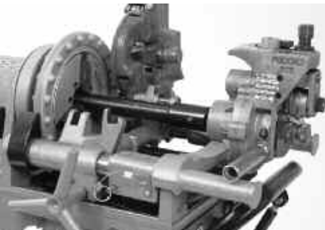
Ilustracja 6 – Rowkarka rolkowa 975 Combo prawidłowo zamontowana na gwinciarce 300 Compact
