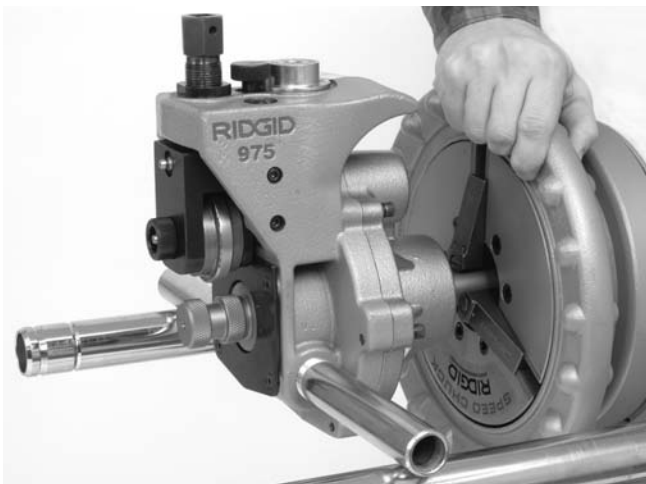
Figure 3 – Montage de la rainureuse à galets mixte n° 975 sur mandrin de système d'entraînement n° 300.
