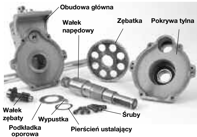
Ilustracja 20 - Części rowkarki rolkowej 975 Combo
