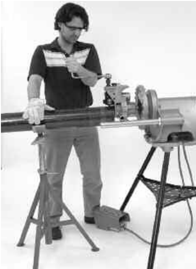
Рисунок 13 – Нажим на трубу с целью улучшения прокатки
