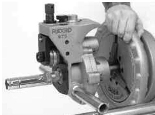
Slika 3 – Montaža 975 kombinovane mašine za valjanje žlebova na 300 steznu glavu pogonske jedinice
