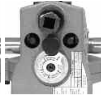
Figuur 15B – Meter in groefstand
