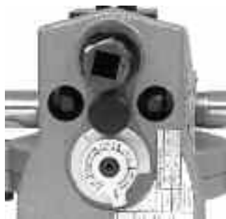
Figura 15A – Colocar a divisão de escala correcta do calibre debaixo da cabeça do parafuso de regulação
