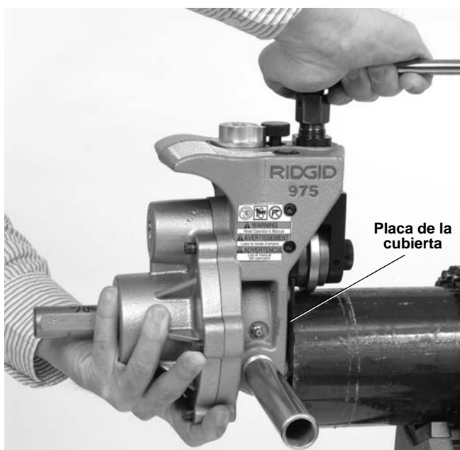
Figura 14 – El operario sujeta firmemente la Ranuradora, sobre un tubo estático, mientras aprieta el tornillo de alimentación
