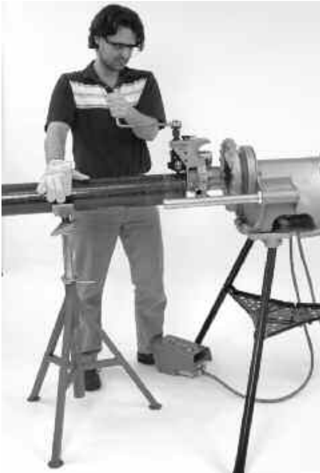
Figur 13 – Legge press på røret ved gjenging for å opprettholde sporing
