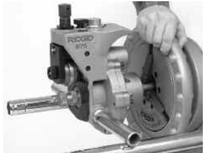
Рисунок 3 – Установка устройства для накатки желобков 975 Combo в зажиме силового привода 300
