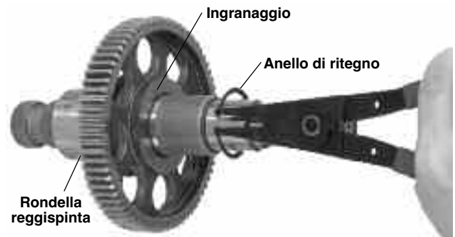
Figura 19 – Rimozione dell'anello di ritegno
