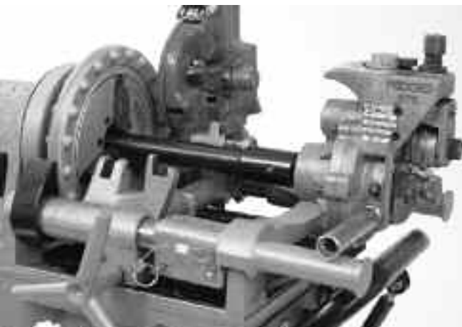
Figur 6. 975 Combo Groover korrekt monterad på 300 Compact Threading Machine
