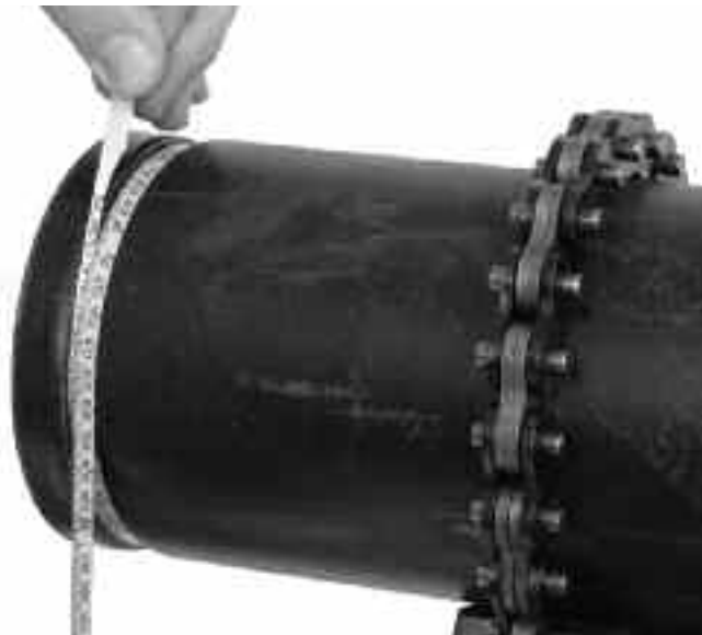
Kuva 11: Uran läpimitan tarkistus läpimittanauhalla
