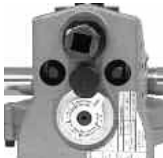
Slika 10B – Kalibar u poziciji za izradu spojnice
