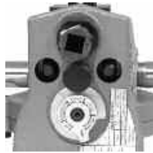
Abbildung 15A: Den richtigen Ansatz der Lehre unter den Kopf der Einstellschraube bringen
