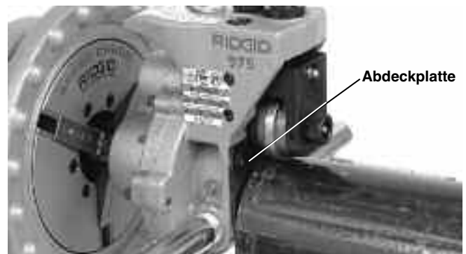
Abbildung 8: Aufsetzen des Rohrs auf die Antriebswelle und bündig mit der Abdeckplatte
