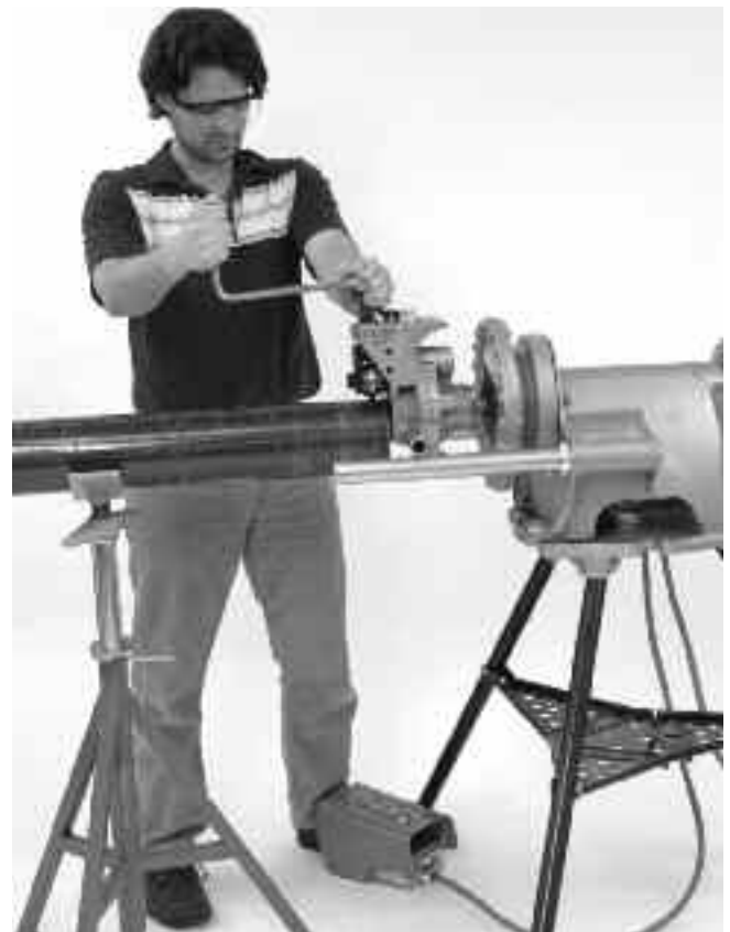
Abbildung 12: Position für den Betrieb des Rollnutgeräts
