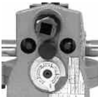
Figura 10A – Colocar a divisão de escala correcta do calibre debaixo da cabeça do parafuso de regulação
