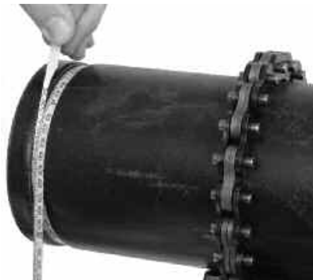
Figur 11 – Aflæsning af rillediameteren med et diametermålebånd
