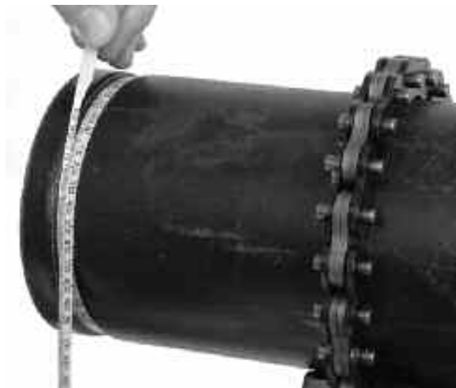
Obrázek 16 – Měření průměru drážky pásovým metrem
