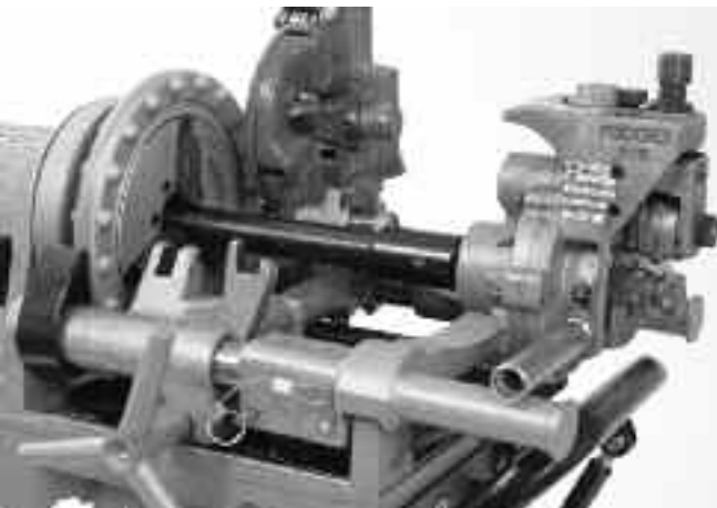
Figura 6 – Scanalatrice combinata a rulli 975 montata correttamente sulla Filettatrice 300 Compact
