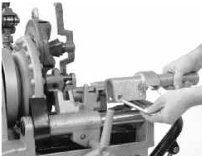
Рисунок 5 – Установка скобы адаптера
