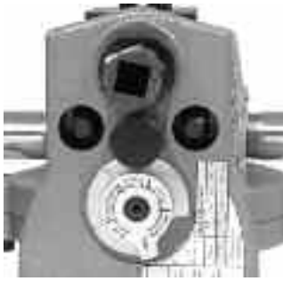
Рисунок 10А – Выбор положения регулятора глубины желобка под головкой регулировочного винта
