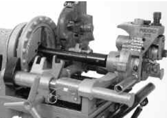
6. ábra: 300 Compact menetvágó gépre helyesen felszerelt 975-ös kombinált görgős csőhornyoló
