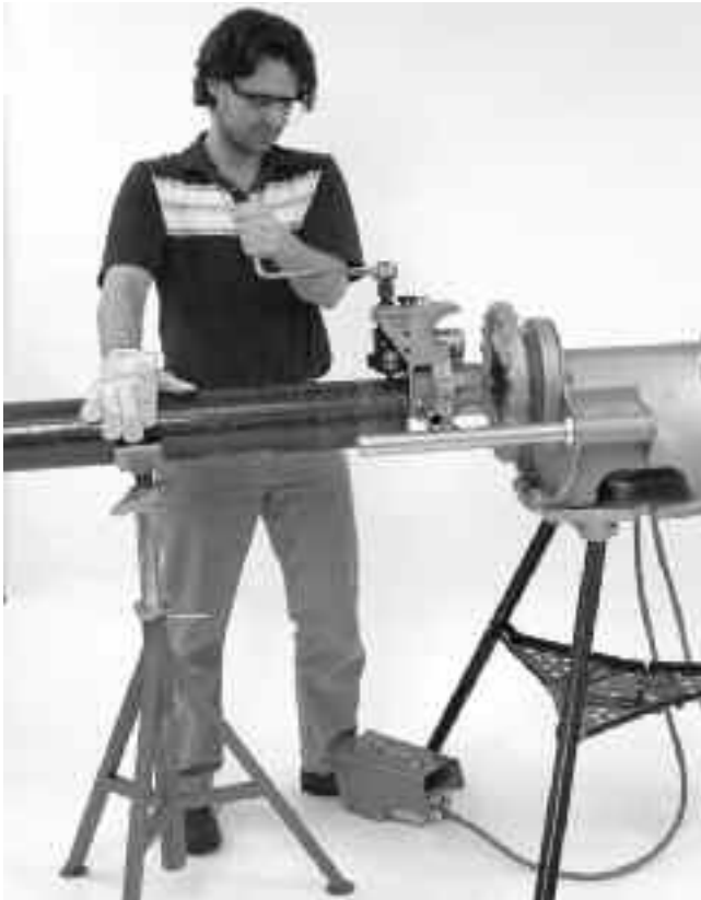
Şekil 13 – Yiv Açılırken Borunun İlerlemesini Sağlamak İçin Boruya Kuvvet Uygulanması
