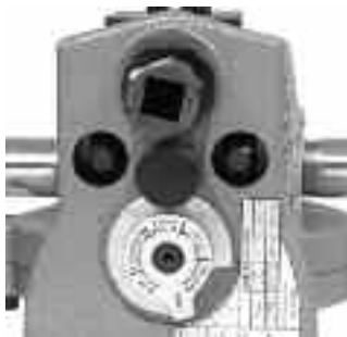
Ilustracja 10A – Ustawić właściwy występ wskaźnika pod łbem śruby regulacyjnej
