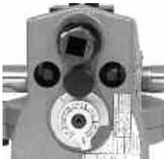
Obrázok 10A – Nastavte správny krok na ukazovateľ pod nastavovaciu skrutkou
