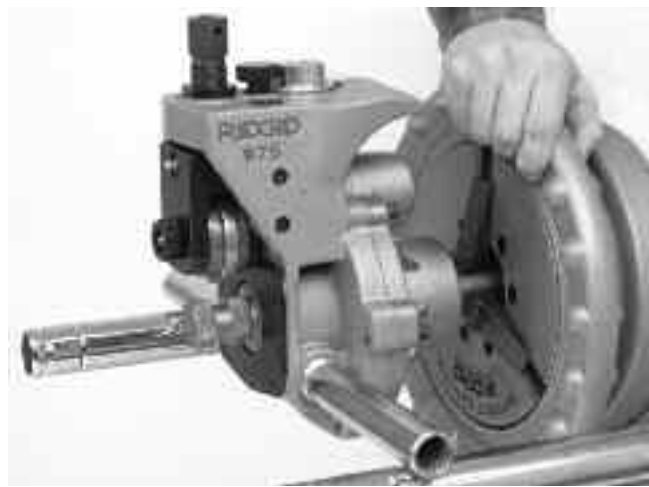
Figur 3 – Montering af 975 Combo notsikkemaskine i 300 rørdrevs spændepatron
