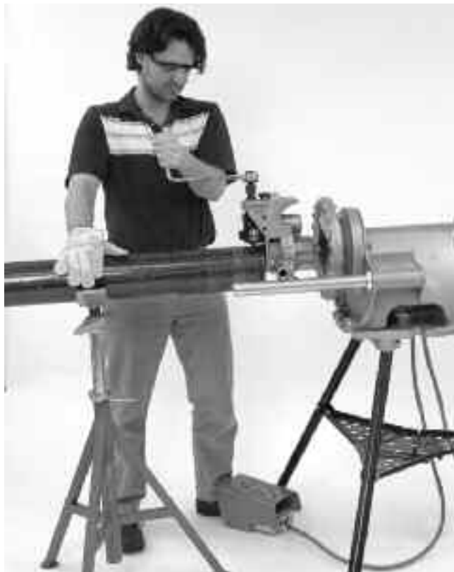
Ilustracja 13 – Przykładanie siły do rury podczas formowania rowka w celu zachowania toru ruchu
