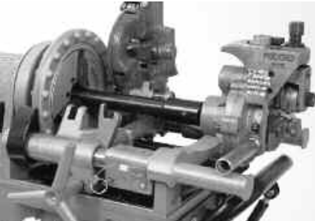
Figuur 6 – 975 Combo rolgroever correct gemonteerd op 300 Compact draadsnijmachine
