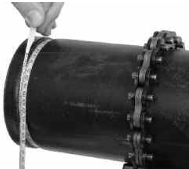
Slika 11 – Provera prečnika žleba trakom za merenje prečnika
