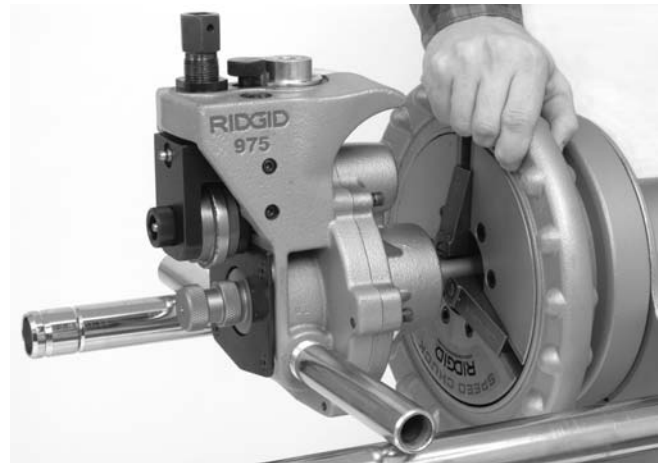
Εικόνα 3 – Τοποθέτηση του 975 Combo Roll Groover στο σφιγκτήρα του 300 Power Drive
