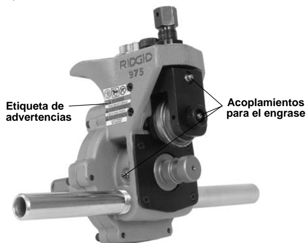
Figura 2 – Etiqueta de advertencias en la Ranuradora No. 975
