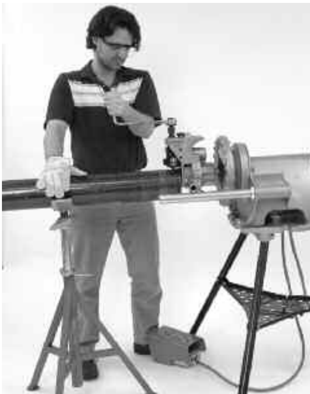
Figura 13 – Applicare forza al tubo durante la scanalatura per mantenere la posizione
