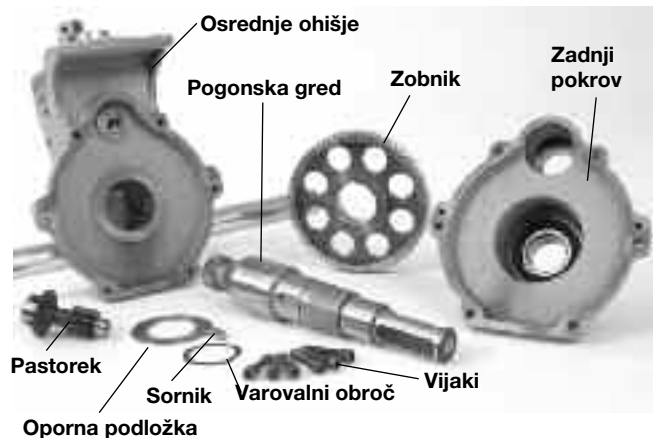
Slika 20 – Pregled delov kombiniranega kolutnega vtiskovalnika utorov 975
