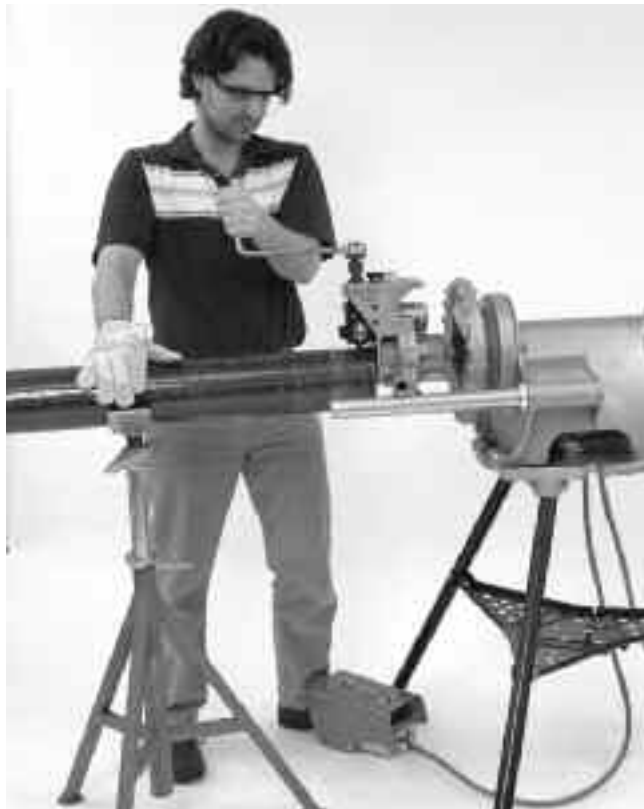
Obrázok 13 – Aplikovanie sily na rúru pri drážkovaní ako opatrenie na zaistenie smerovej stability
