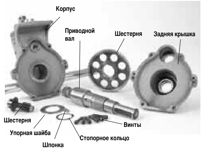
Рисунок 20 – Обозначение компонентов устройства для накатки желобков 975 Combo
