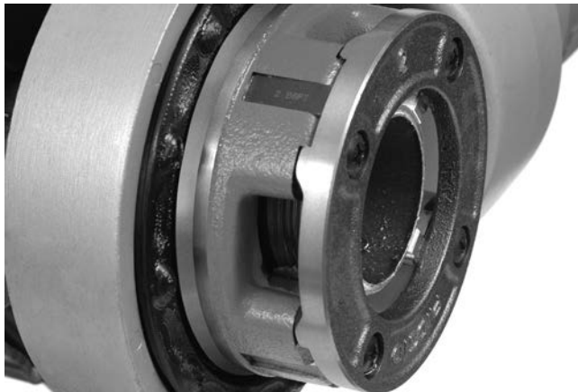
Figure 15 – Tuyau arrivé à fleur des filières
