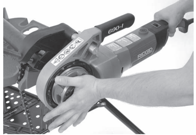
Şekil 13 - Diş Açmaya Başlama
