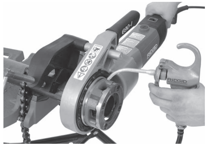
Şekil 14 - Boruya Diş Açılması
