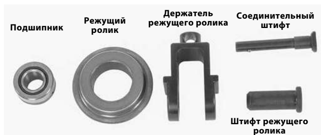
Рис. 15 - Замена режущего ролика
