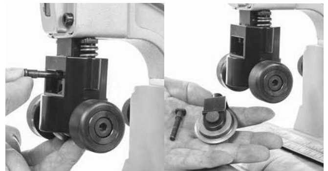
Рис. 14 - Снятие держателя режущего ролика
