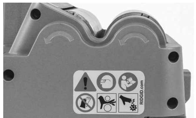
Рис. 5 - Направление вращения роликов
