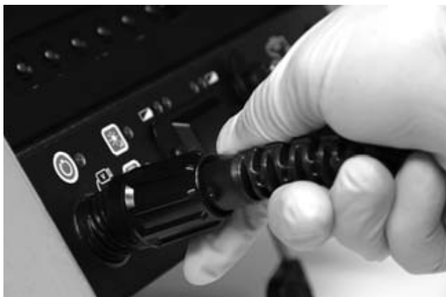
Рис. 17 – Подсоединение к блоку CCU SeeSnake
