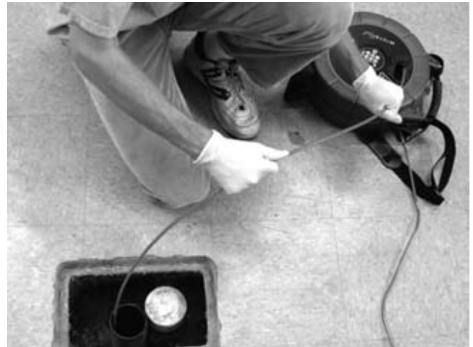
Рис. 28 – Надлежащий метод проталкивания кабеля назад в барабан
