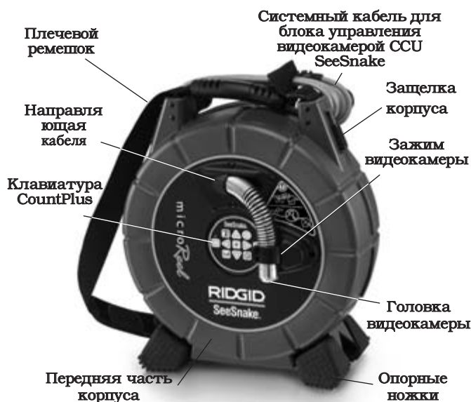
Рис. 1 – Вид спереди (Конфигурация SeeSnake)
