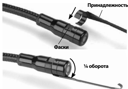
Рис. 8 - Установка принадлежности
