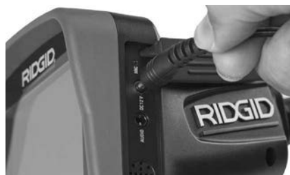
Рис. 6 - Питание прибора от адаптера переменного тока
