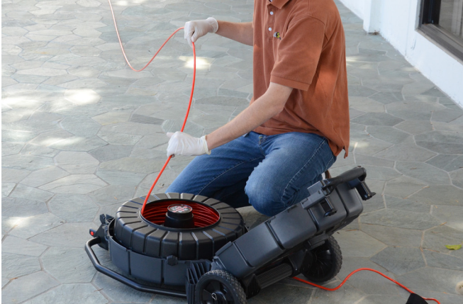
Рисунок 26 – Вращайте барабан, чтобы правильно намотать проталкивающий кабель
