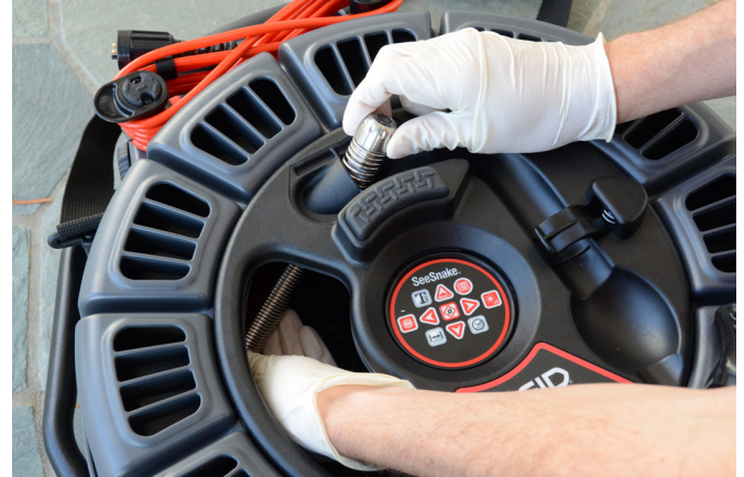
Рисунок 28 – Укладка головки камеры
