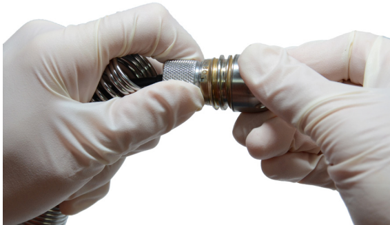
Рисунок 23 – Демонтаж головки камеры
