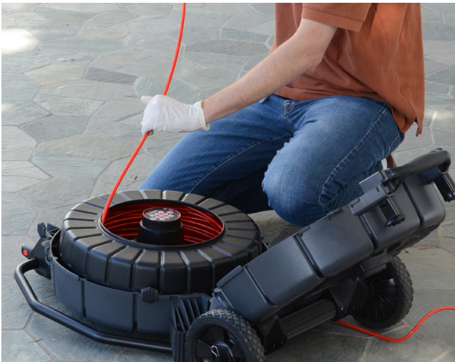
Рисунок 27 – Как направлять проталкивающий кабель в барабан
