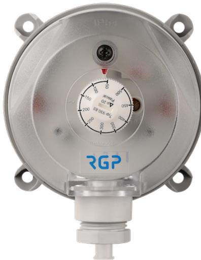
**Датчики перепада давления DPS** - серия простых и надежных реле перепада давления с диапазонами регулировки 200 Па до 2500 Па, которые предназначены для контроля состояния работы вентиляторов, воздушных фильтров, рекуператоров и других элементов вентиляционных систем.
