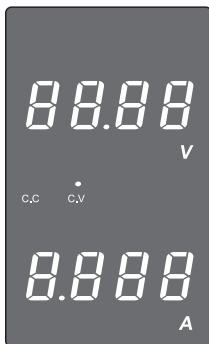
Рис. 6 Экран источника питания PS-1305
