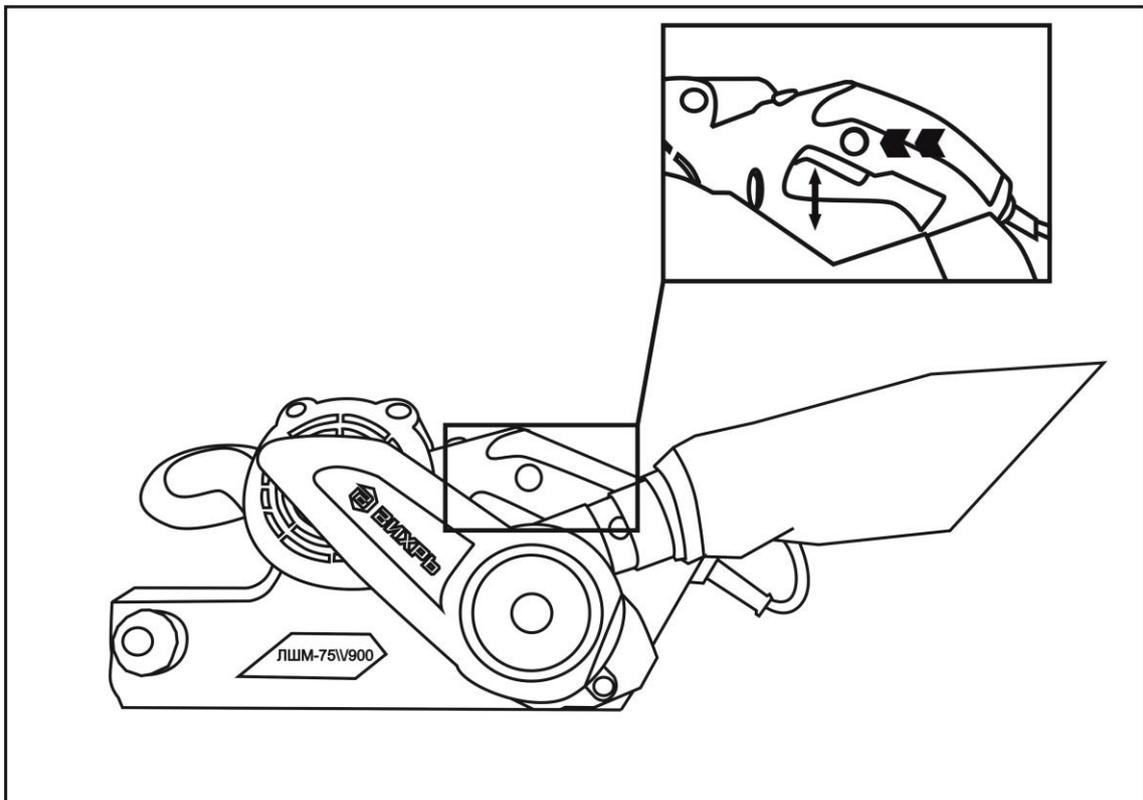
Рис.5 Клавиша выключателя
