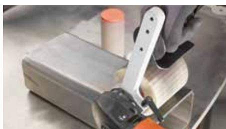
Доведение поверхности до зеркального блеска после нанесения пасты для черного полирования
