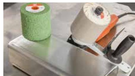
Дальнейшая обработка поверхности с помощью втулок K400, K800 и K1400, подготовка к полированию
