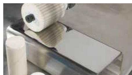
Оптимальный зеркальный блеск поверхностей из высококачественной стали после обработки с помощью матирующей пасты
