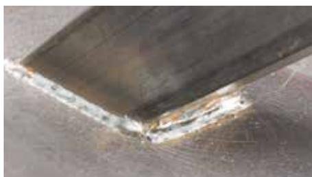
Необработанные сварные швы с цветами побежалости на металлических конструкциях
