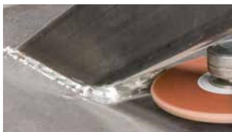
Сошлифовка сварных швов на труднодоступных конструкциях
