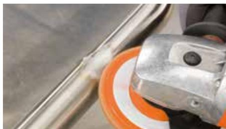
Удаление сварного шва без повреждения прилегающей поверхности
