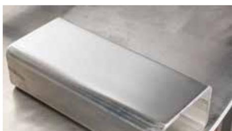
Предварительная шлифовка поверхности (до K1400) для устранения всех царапин
