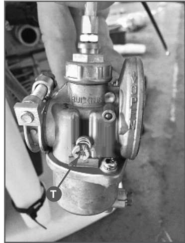
Рис. 16 Расположение винтов регулировки карбюратора
