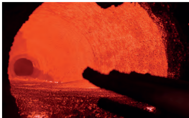
Производство клинкера (процесс обжига)
