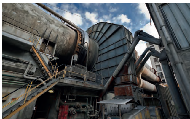
Обжиг гранулированного сырья в установке предварительного нагрева и роторной печи
