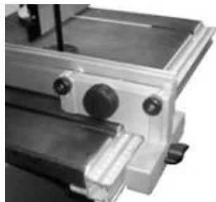
Для точной обработки большого количества одинаковых изделий в комплекте ленточной пилы имеются упор с линейкой и транспортир, с помощью которых устанавливается длина обрабатываемого изделия и угол среза на нём.
