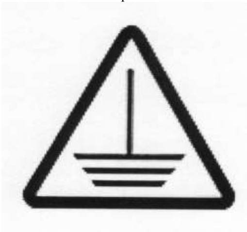
Точка заземления системы
