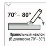
Качество сварки зависит в основном от опыта рабочего, от вида сварки и от качества электрода, поэтому выбирайте подходящий электрод до того, как приступите к сварке, учитывая толщину и состав свариваемых металлов. Сварочный процесс представляет собой сложный комплекс методов и приемов, различных технологий и правильного подбора материалов. Для получения качественных соединений необходимо пользоваться профильной литературой.
