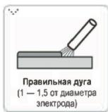
Очень важно, чтобы длина дуги была правильной, т.к. это влияет на сварочный ток и напряжение. Непрочный сварочный шов является результатом неправильного тока сварки. Наклон электрода (вперед) должен составлять  $70^\circ$  или  $80^\circ$ . При слишком большом наклоне сварочный шов может стать пористым.
