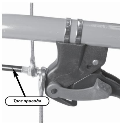
Со временем тросы привода могут растянуться. Для их регулировки необходимо расконтрить гайку и добиться оптимального натяжения тросов. Оптимальной регулировкой троса является начало движения культиватора при нажатом рычаге сцепления на  $\frac{1}{3}$ .
