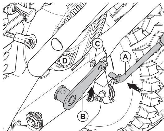
Установите на снегоуборочной машине в отверстие коннектора (B) тягу (A) и закрепите.
