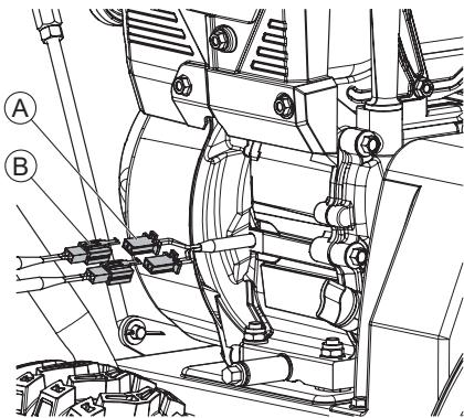
Для комфортного использования снегоуборочной машины она снабжена фонарем освещения и подогревом рукояток. Произведите подключение разъемов электрического кабеля (A) (B). Закрепите токоведущую проводку на нижней рукоятке пластиковыми клипсами, для исключения попадания проводов в зону вращения гусениц.
