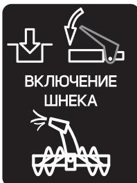
Нажмите на рычаг привода шнека по направлению к ручке управления, шнек начнет вращение и можно начинать расчистку снега. Для отключения шнека отпустите рычаг.
