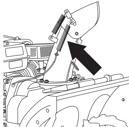
Подключите трос регулировки наклона дефлектора.
