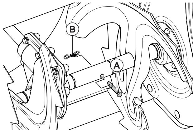
Шнеки крепятся к валу с помощью предохранительных (резьбовых) штифтов со шплинтами или гайками. В случае столкновения шнека с посторонним предметом или ледяным затором штифты срезаются и шнек перестает вращаться, предотвращая повреждения других частей снегоуборщика. Если шнеки в момент включения не врашаются, то следует проверить, не срезаны ли штифты. При необходимости замените предохранительные штифты.
