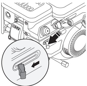
**Примечание!** Для повторного запуска горячего двигателя возможно оставить рычаг воздушной заслонки в положении «**ОТКРЫТО**».
