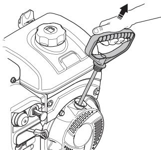
**Примечание!** Не рекомендуется вытягивать шнур стартера максимально (на всю длину), а также резко отпускать его при повторной попытке завести двигатель. Удерживая рукоятку, плавно верните его в исходное положение.
