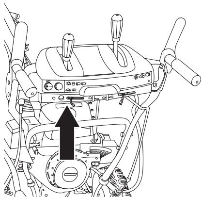
Установите на верхней рукоятке в приемное отверстие рычага переключения передач тягу (A).
