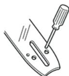
Очистку шины и проверку степени износа производите после каждой эксплуатации. Для этого снимите шину, прочистите масляные каналы, паз пильного полотна и смазочное отверстие звездочки. Добавьте несколько капель масла в смазочное отверстие звездочки.
