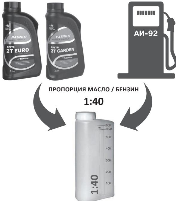
Смесь следует готовить из расчета на одну заправку, не следует оставлять надолго смесь в топливном баке бензопилы.
