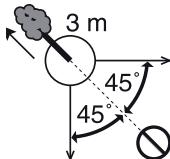
Прежде чем приступить к валке дерева определите направление его падения, учитывая расположение естественного наклона, преобладающего расположения ветвей. Учтите расположение других деревьев, строений и линий электропередач. Расчистите зону вокруг дерева. Выберите путь к отходу (не менее 3 метров), противоположный падению дерева.
