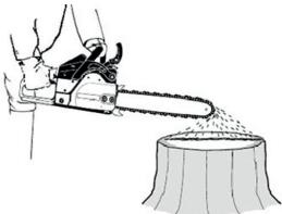
Перед каждым использованием проверяйте работу маслонасоса, для этого расположите пилу пильной шиной над светлым сухим предметом, нажмите на курок газа наполовину от максимального и удерживайте в таком положении до 30 сек., образуется след от
