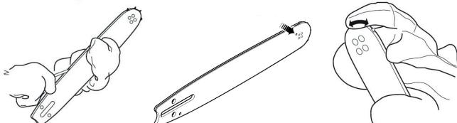
Из-за естественного износа шины на ней могут появляться заусенцы, уберите заусенцы с шины напильником, в противном случае шина будет изнашиваться интенсивней.
