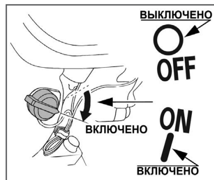
Рис. 12 Выключатель зажигания в положении «Включено»
