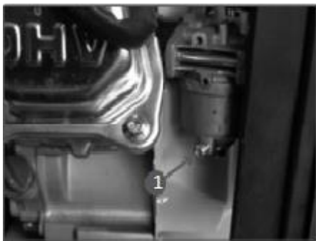
Рис. 24 Обслуживание фильтра отстойника Т-50 1. Винт
