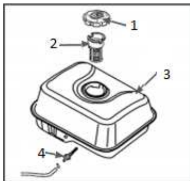
Рис. 22 Расположение топливных фильтров
