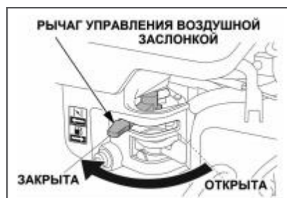
Рис. 15 Рычаг управления воздушной заслонкой T-60, T-80, T-90, T-100.
