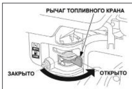
Рис. 16 Рычаг топливного крана T-60, T-80, T-90, T-100
