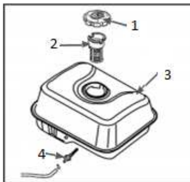
Рис. 22 Расположение топливных фильтров
