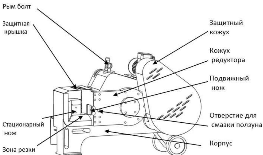
Двигатель, через маховик и редуктор передает вращение на коленчатый вал, соединенный с подвижным ножом посредством шатуна. Таким образом, реализуется возвратно-поступательное движение ножа, и, соответственно, резка арматуры. Кинематическая схема станка дана ниже.
