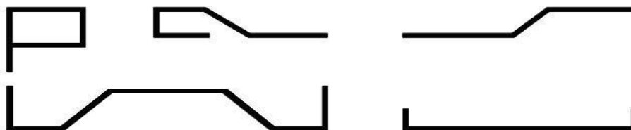
Рис. 1 Формы изгиба арматуры
