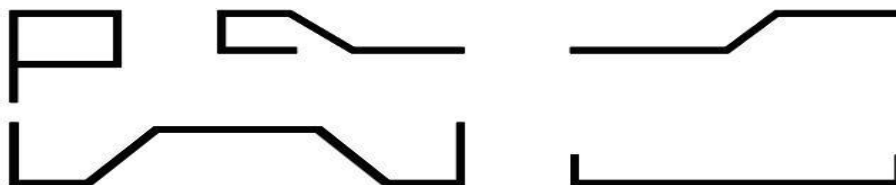
Рис. 1 Формы изгиба арматуры
