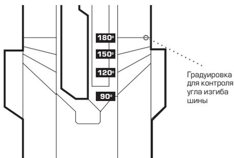
Угол изгиба шины контролируется по рискам на откидной планке. Риски соответствуют определенному углу изгиба.
