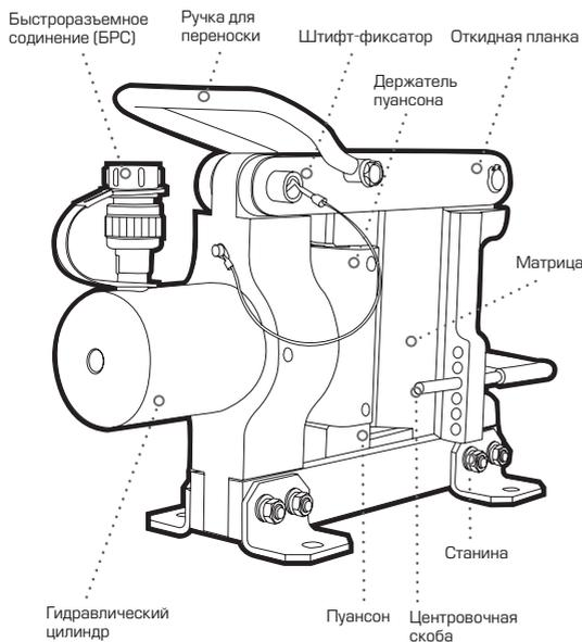
Пресс гидравлический для гибки шин ШГ-150 NEO (КВТ) состоит из станины на которой закреплен гидравлический цилиндр. Станина имеет отверстия для стационарного крепления пресса. Рабочая жидкость подается от выносной помпы по рукаву высокого давления через быстроразъемное соединение (БРС) в полость гидравлического цилиндра, воздействуя на поршень. Поршень под давлением рабочей жидкости перемещает сменный пуансон, который воздействует на электротехническую шину, опирающуюся на матрицу.
