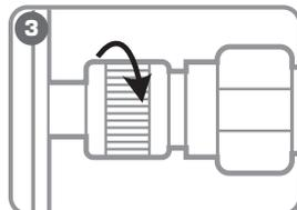
**3** Плотнo затяните гильзу БРС, приложив достаточное усилие (от руки) для обеспечения хорошего соединения (без применения слесарного инструмента)
