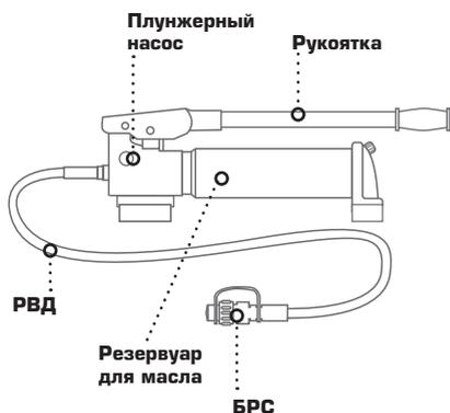
В помпе применён двухступенчатый плунжерный насос, имеющий две ступени нагнетания давления (кроме ПМП-7003). Первая ступень – низкого давления – позволяет обеспечивать подачу рабочей жидкости в достаточном объеме для ускорения движения поршня исполнительного устройства без нагрузки. Вторая ступень – высокого давления – способна создавать рабочее давление, необходимое для нормального функционирования исполнительного устройства. Переход с одной ступени на другую происходит автоматически.
