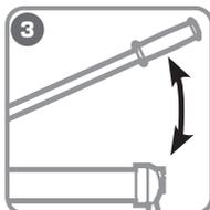
Нагнетайте давление рукояткой до завершения операции (при опрессовке - смыкание матриц, при резке - полное перерезание кабеля)
