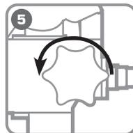
**5** После завершения рабочего цикла сбросьте давление, повернув винт сброса давления в положение «Открыть»
