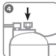
Закройте заднюю крышку/сливную пробку, удалите воздух из системы
